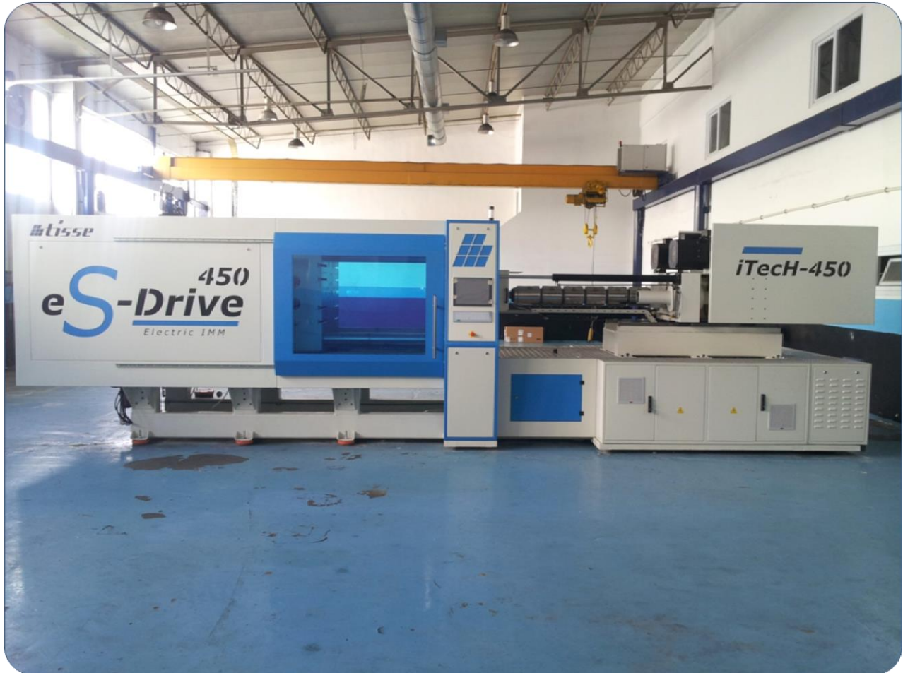
eS-Drive450 Tisse Maschine, die erste Hybrid-Maschine für Kunststoffspritzguss: Geschwindigkeit und energiesparend
