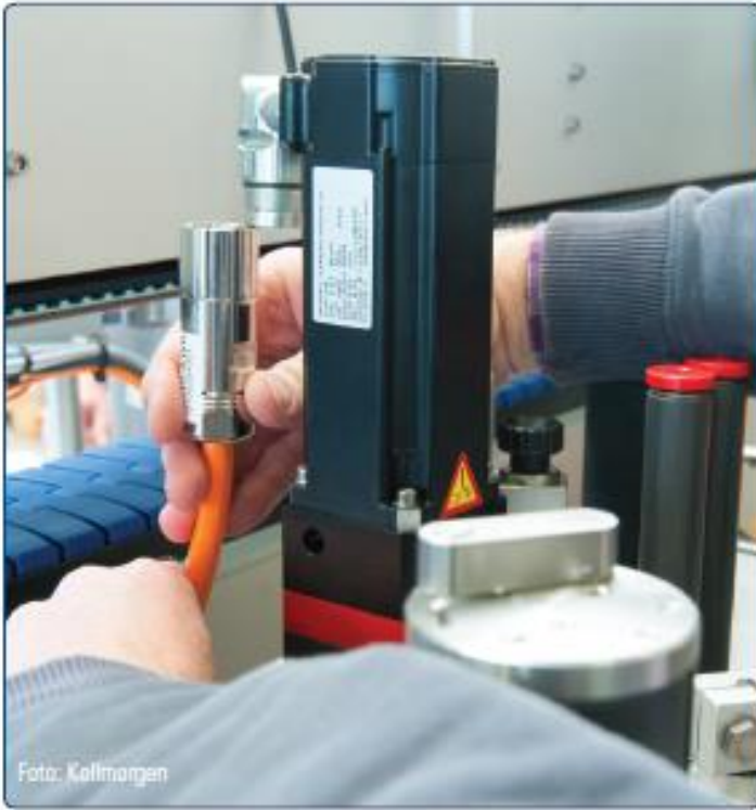
Tek kablolu bağlantı teknolojisi sayesinde Schleuter'in kurulum süresi daha kısadır.
