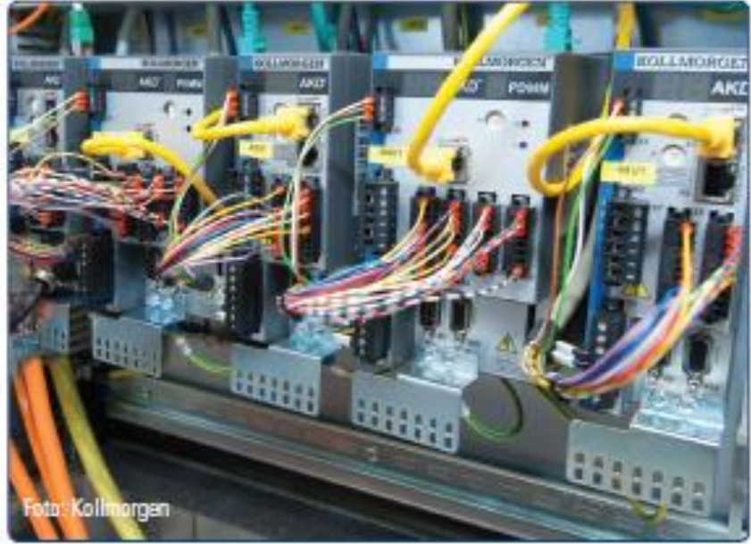
AKD PDMM serisi akıllı servo dönüştürücüler, bir "IPC inside"ın sahip olduğu bilgisayar performansını sunar. Schleuter'de EtherCAT üzerinden iletişim sağlanır.
