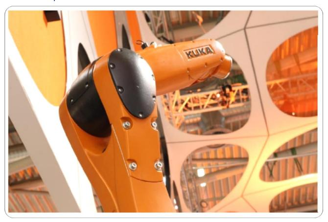
Le prestazioni della serie KR Agilus entro il suo range di carico nominale fissa nuovi standard in termini di velocità, tempi ciclo ed energia erogata. Questi robot possono anche gestire operazioni insolite nelle posizioni di montaggio a pavimento e a soffitto. KOLLMORGEN ha sviluppato i motori custom adattando motori della serie di servomotori AKM standard senza compromettere né prestazioni, né qualità.
