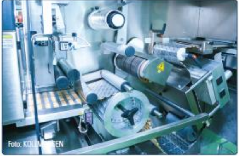
Makinedeki işlem süreci sırasıyla kabarcık oluşumu, asıl tablet düşürme, kabarcığın mühürlenmesi ve son olarak kabarcığın kesilmesidir.
