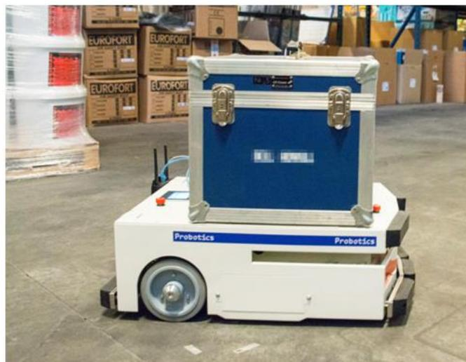
*Bis zu 150 Kilogramm Nutzlast können die 40 Kilogramm schweren AIV transportieren*
