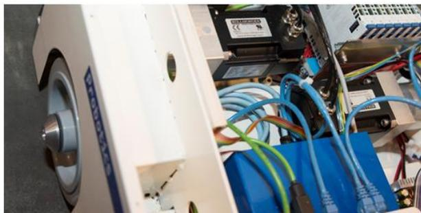
Als Antrieb für die beiden Räder setzt Optec Synchronservomotoren der KOLLMORGEN-Reihe AKM in einer 48 Volt Variante ein
