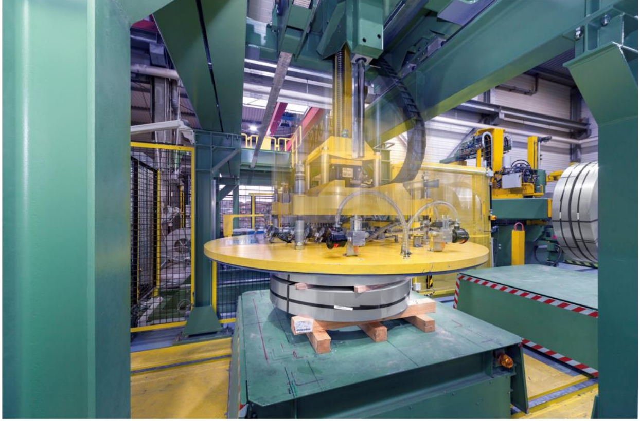
Yükün indirilmesinde ortaya çıkan fren enerjisi KOLLMORGEN'in KCM-modülü tarafından geçici depolanıyor.
