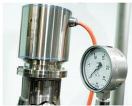
La tecnica di collegamento a cavo singolo dei servomotori è estremamente vantaggiosa dal punto di vista dell'igiene.
