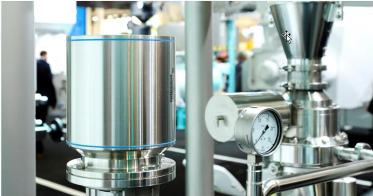
*Con il motore in acciaio inossidabile AKMH di KOLLMORGEN Bühler aziona pompe, dosatori e un agitatore centrifugo.*
