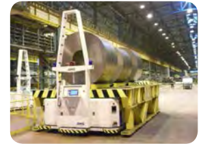
Dünyanın sürücüsüz, 16 tekerleği control edilen ilk aracı, Posco Steel, Güney Kore, 2009
