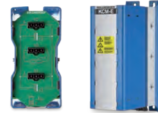
KCM-E Geliştirme modülleri ile enerji rezervleri neredeyse sınırsız olarak büyür. Enerji boşalma direnci her modüle entegredir. Bağlantı; teslimatta gönderilen, modülün üst yüzündeki priz bağlantısı üzerinden, ters kutup korumalı kablo aracılığı ile sağlanır.
