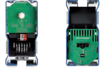
KCM-P basitçe konvertörün eşit akım ara devresine bağlanır. Şebeke kesintisi dijital arayüzde makina kumandasının değerlendirilmesi için bir sinyal verir.
