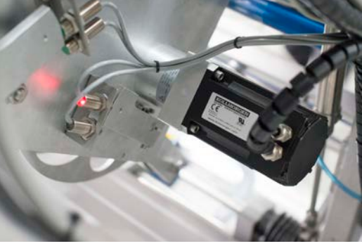
AKM31K ile bir ambalajlama makinasının etiketleme biriminde kontrol çözümü
