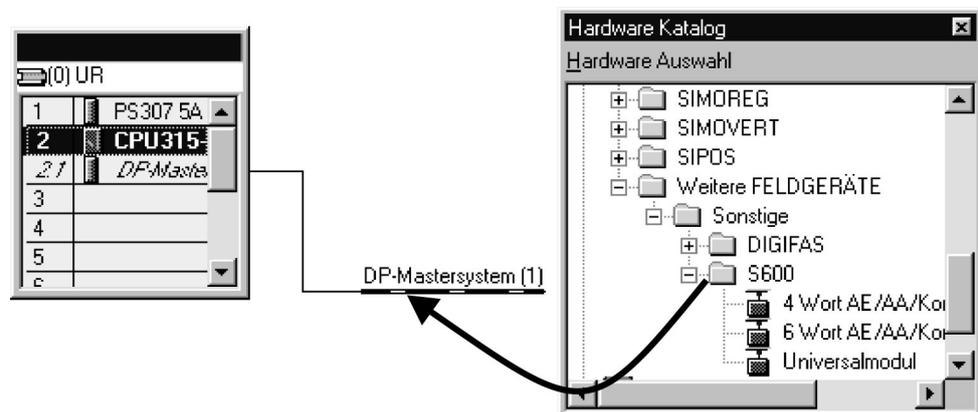
Ziehen Sie nach dem gleichen System wie oben die Module aus dem Hardware-Katalog in die Box des Feldgerätes, so dass das 4-Wort Modul im Fach 0 und das 6-Wort Modul im Fach 1 liegt.
