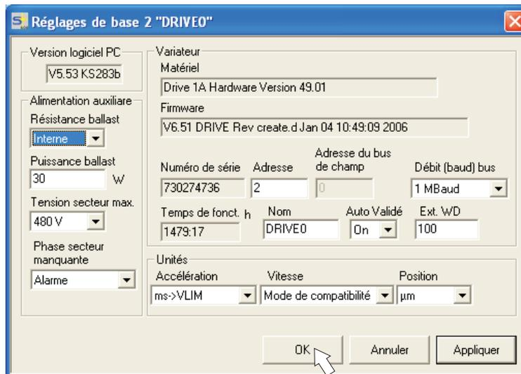
**Résistance ballast** : ne modifier cette valeur que lorsqu'une résistance de freinage externe est utilisée. La plupart des applications ne nécessitent pas de résistance de freinage supplémentaire.
