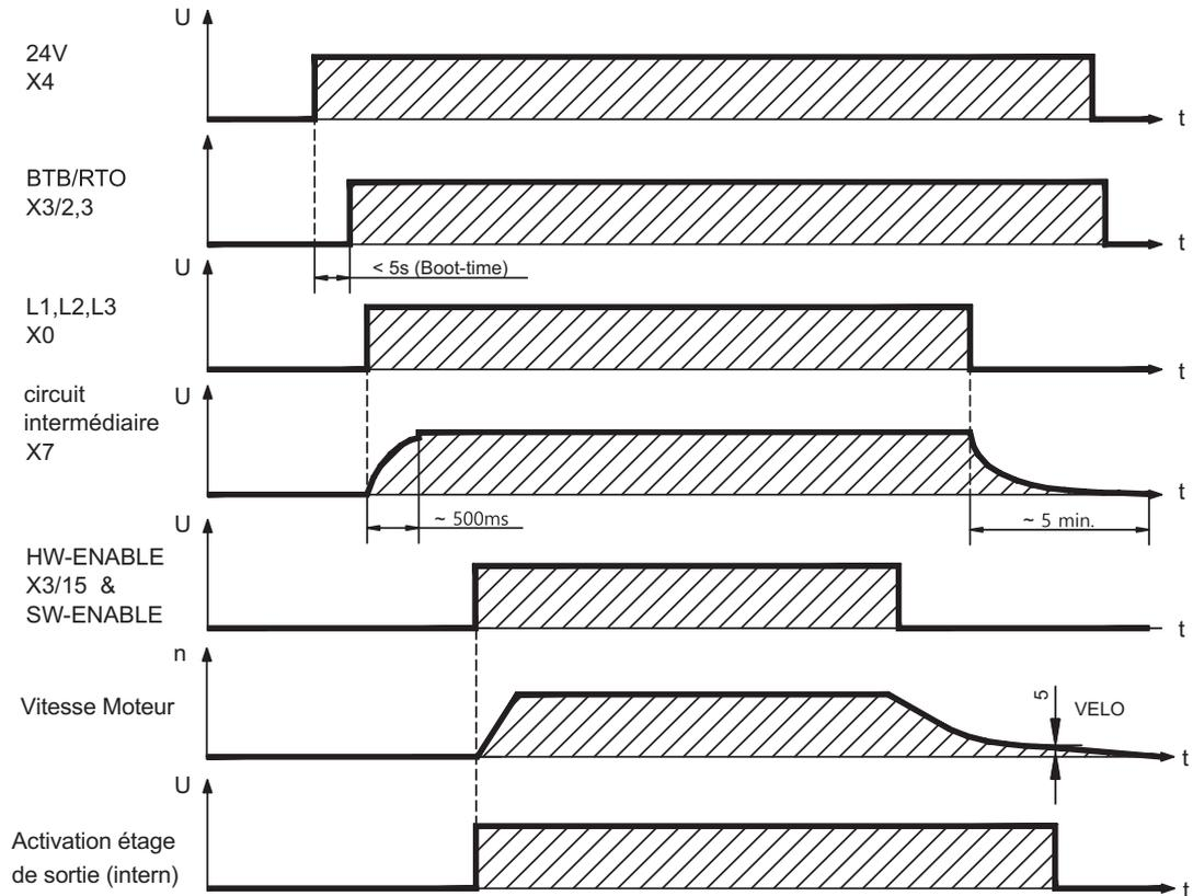
Les appareils avec sélection de la fonction «frein» disposent d'un déroulement séparé pour la mise hors service de l'étage final (⇒ p.26).
