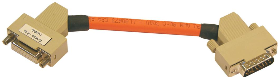
Les résistances de terminaison augmentent l'immunité. L'adaptateur d'environ 200 mm de long est raccordé au variateur (X1).
