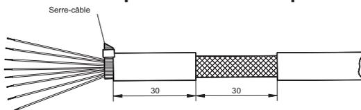
Retirez la gaine extérieure du câble et la tresse de blindage à la longueur de conducteur voulue. Mettez des courts-circuits aux conducteurs à l'aide d'une bride de fixation.
