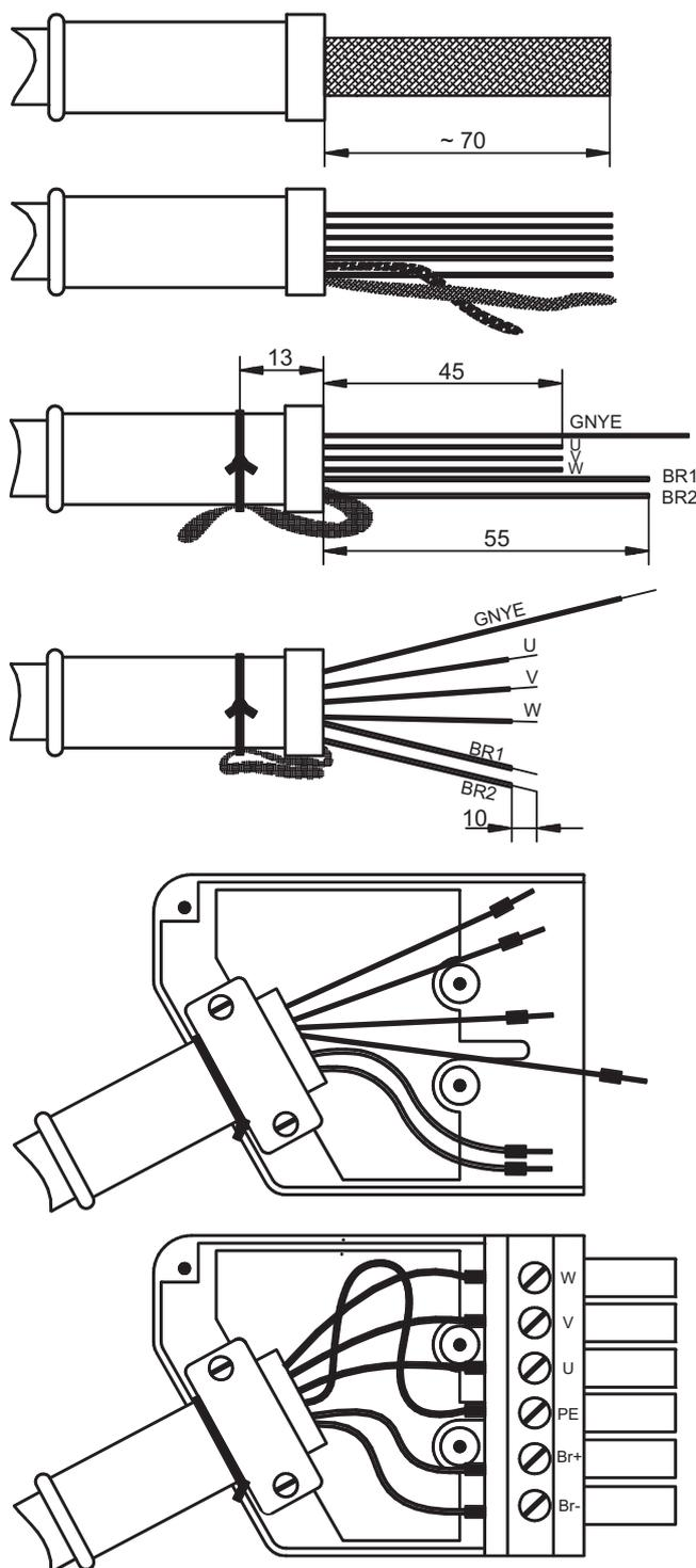
Introduisez **d'abord** l'embout en caoutchouc sur le câble et retirez **ensuite** la gaine extérieure sur une longueur de 70 mm, sans endommager le blindage.
