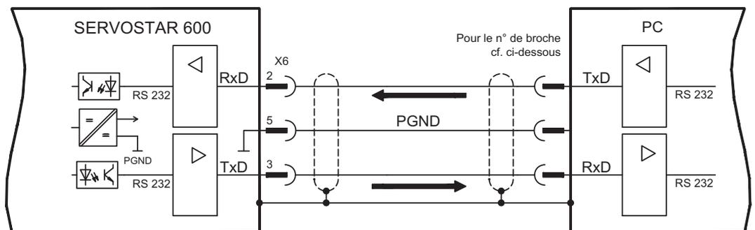
Sur le module d'expansion optionnelle -2CAN- les deux interfaces RS232 et CAN, qui occupent normalement le même connecteur X6, sont réparties sur deux embases distinctes. (⇒ p.113).
