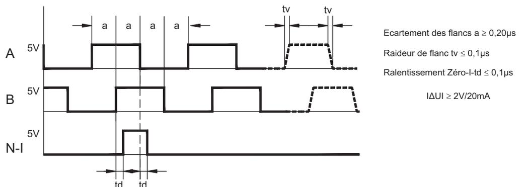
8.13.2 Sortie SSI, absolu synchrone sérielle (X5)
