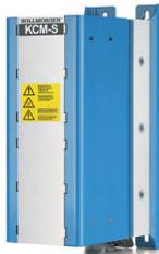
Les modules **KCM** (**KOLLMORGEN** Capacitor Module) absorbent l'énergie cinétique produite par le moteur en mode générateur. Normalement, cette énergie est transformée en puissance dissipée via les résistances de freinage. Les modules KCM réinjectent l'énergie stockée dans le circuit intermédiaire dès que c'est nécessaire.
