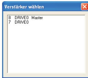
Dargestellt werden die im System erkannten Master- und Achsmodule mit ihrer Stationsadresse und Namen. Das Mastermodul ist gesondert gekennzeichnet. Doppelklicken Sie auf den Verstärker, den Sie in Betrieb nehmen möchten.
