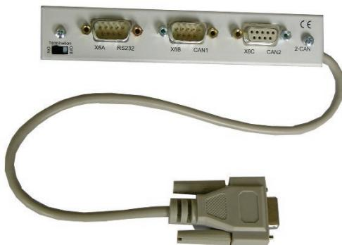
Штекерный разъем X6 сервоусилителя SERVOSTAR предназначен для сигналов интерфейса RS232 и интерфейса CAN. Поэтому расположение выводов интерфейсов не является стандартным и, если вы собираетесь использовать оба интерфейса одновременно, для них требуется специальный кабель. Модуль расширения шины 2CAN представляет интерфейсы с раздельным исполнением разъемов SubD. Оба разъема CAN (CAN-IN и CAN-OUT) подключаются параллельно.
