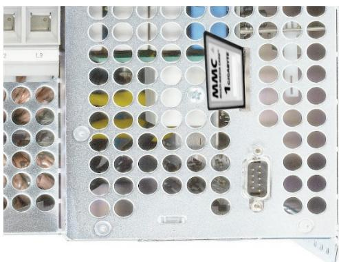
Сверху в сервоусилителе находится устройство для считывания карт MMC. При помощи кнопок управления или ПО для ввода в эксплуатацию на карте памяти можно сохранить ПО и полный набор параметров и снова загрузить их в сервоусилитель.
