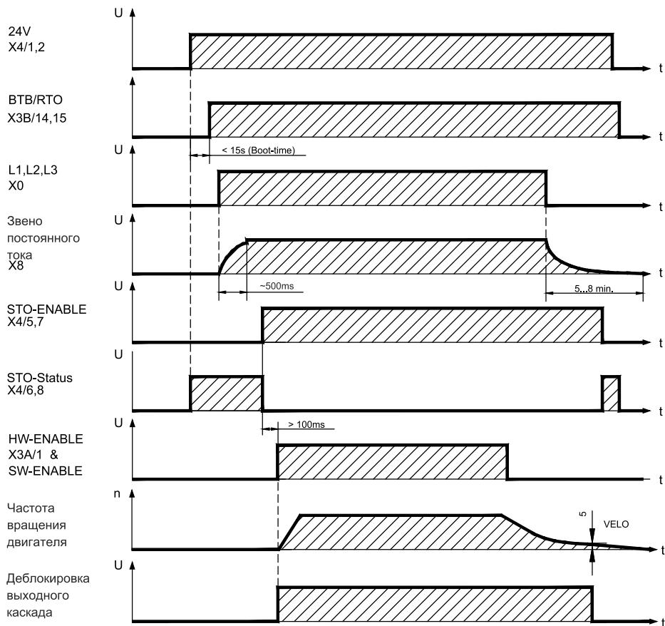
Приборы с разблокированной функцией «Стояночный тормоз» обладают специальным циклом для отключения выходного каскада ( $\Rightarrow$  стр. 29).
