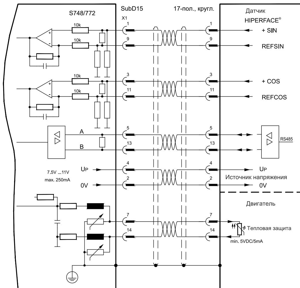
Расположение выводов со стороны датчика относится к двигателям Kollmogen (Ссылка подключение – двигателю С).
