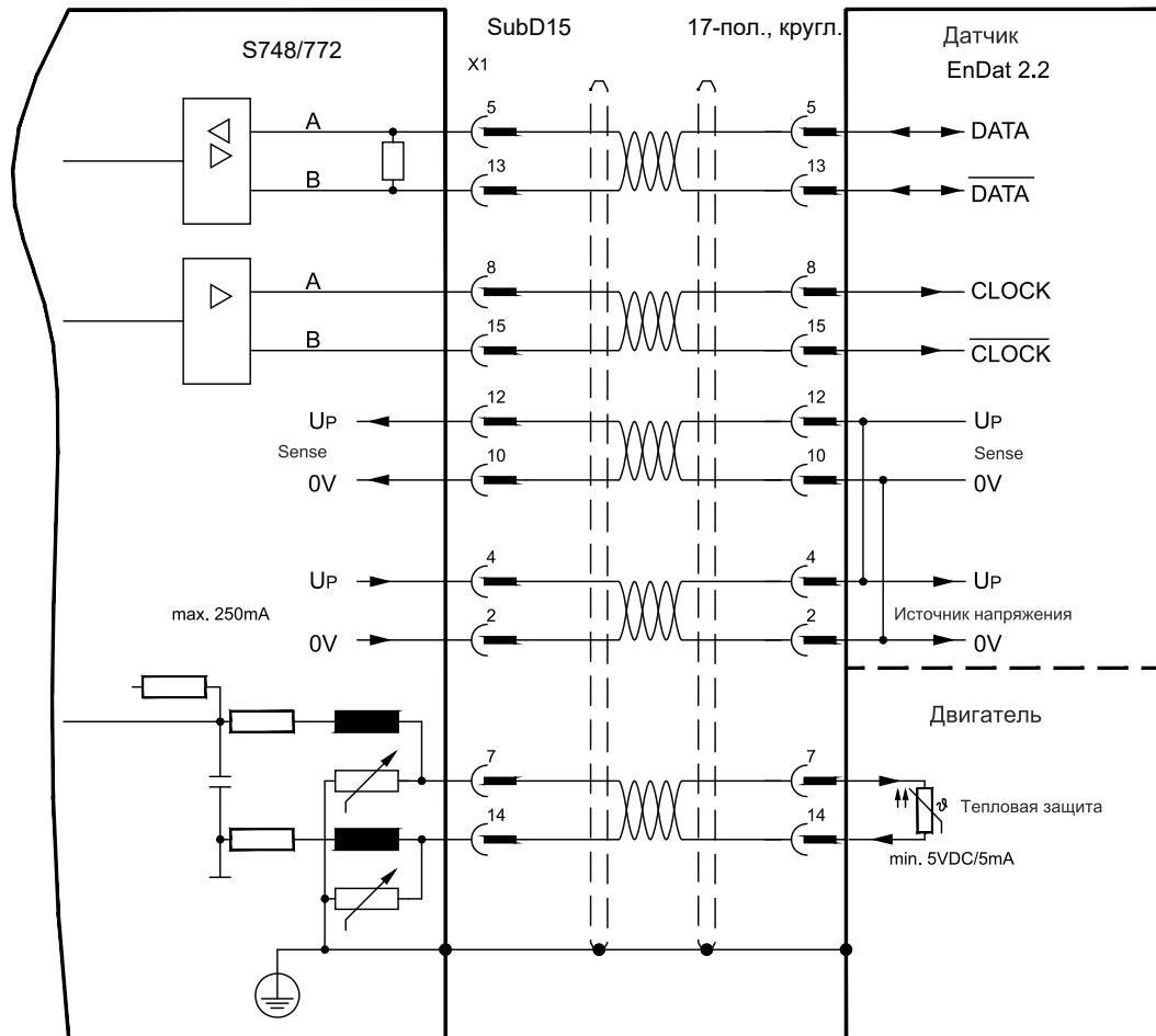
Расположение выводов со стороны датчика относится к двигателям Kollmorgen (Ссылка подключение – двигателю C).
