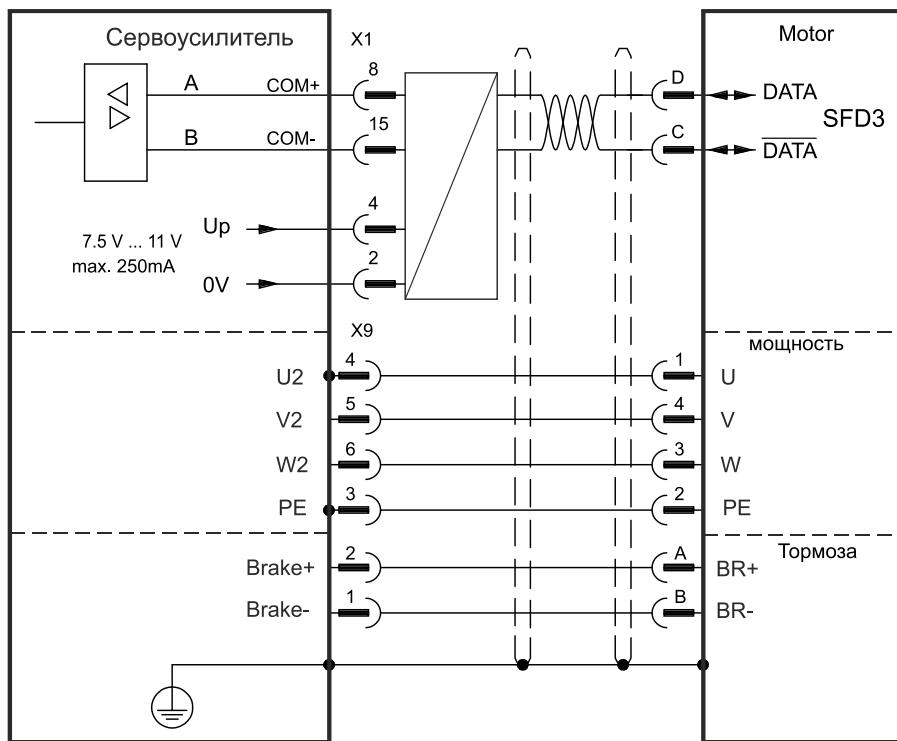
Расположение выводов со стороны датчика относится к двигателям Kollmorgen (Ссылка подключение – двигателю D).
