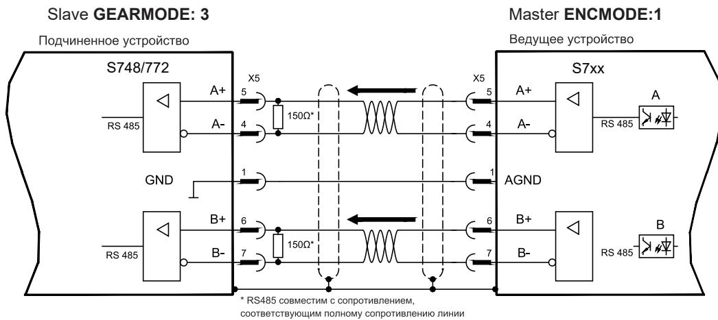
Если бы в качестве эмуляции использовался интерфейс SSI, для ведущего сервоусилителя нужно было бы настроить ENCMODE 2, а для ведомого — GEARMODE 5.
