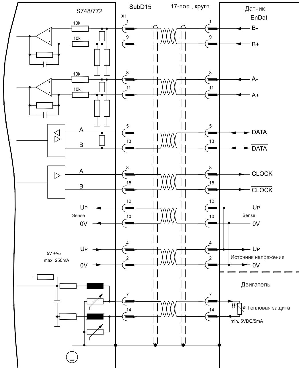
Расположение выводов со стороны датчика относится к двигателям Kollmogen (Ссылка подключение – двигателю С).
