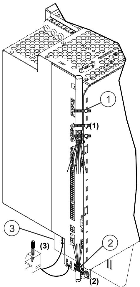
Снимите внешнюю оболочку кабеля и экранирующую оплетку до желательной длины жил. Закрепите жилы кабельным хомутом.
