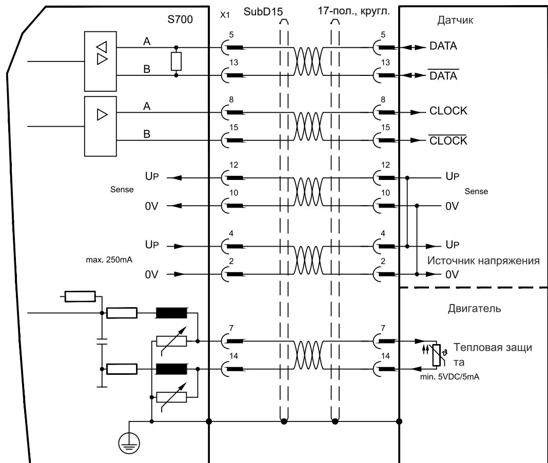
Расположение выводов со стороны датчика относится к двигателям Kollmorgen (Ссылка подключение – двигателю С).
