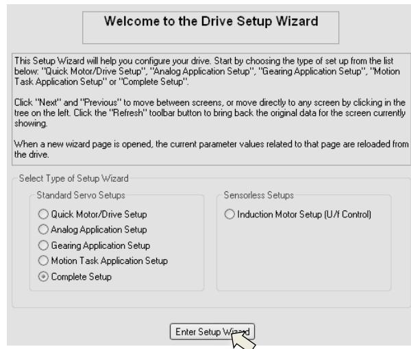
Для быстрого тестирования функций выберите тип установки «Quick Motor/Drive Setup» (Быстрая настройка)
