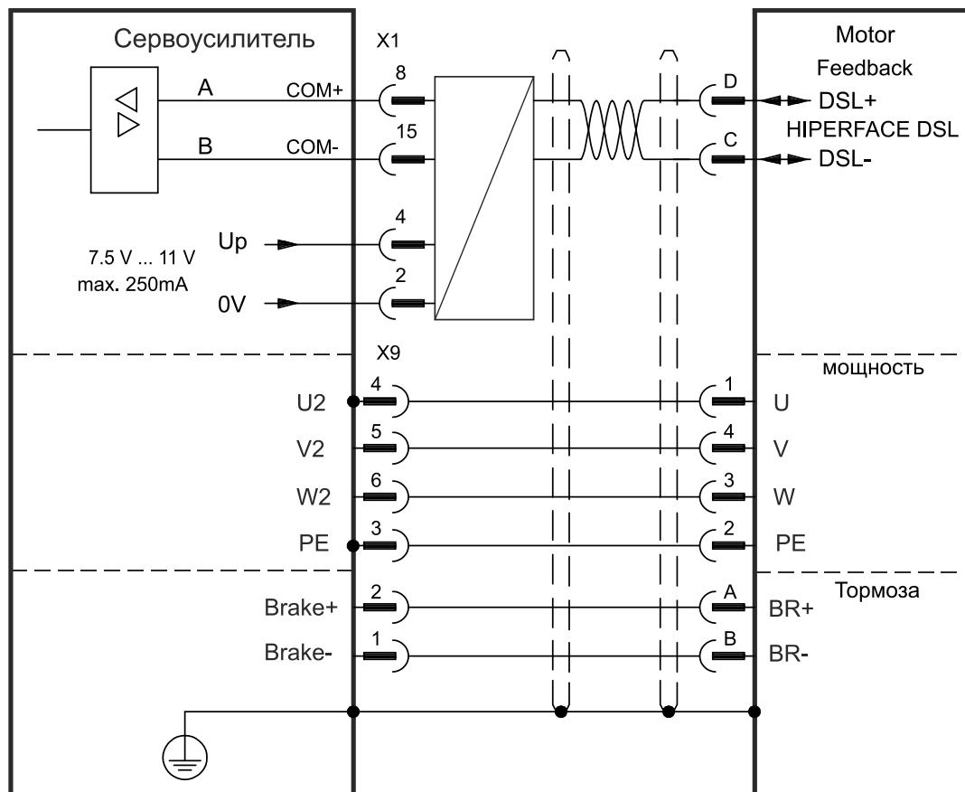
Расположение выводов со стороны датчика относится к двигателям Kollmogen (Ссылка подключение – двигателю D).
