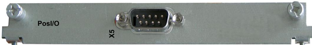
Эта плата расширения представляет собой дополнительный штекерный разъем SubD X5 с высокоскоростными двунаправленными цифровыми входами/выходами 5 В. ПО для ввода в эксплуатацию позволяет выбирать различные функции входов и выходов, например:
