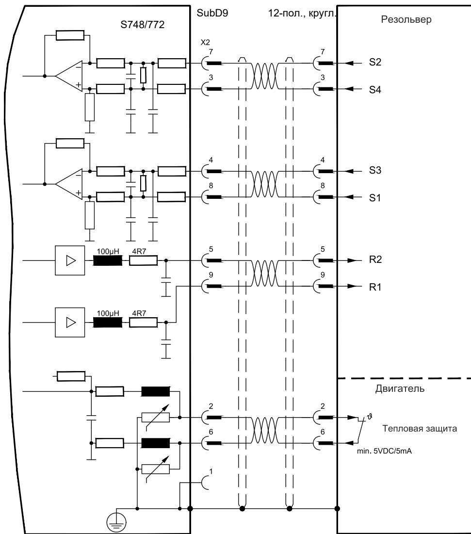
Расположение выводов со стороны датчика относится к двигателям Kollmogen (Ссылка подключение – двигателю С).
