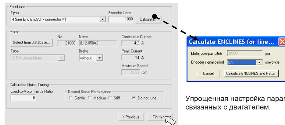
Упрощенная настройка параметров, связанных с двигателем.
