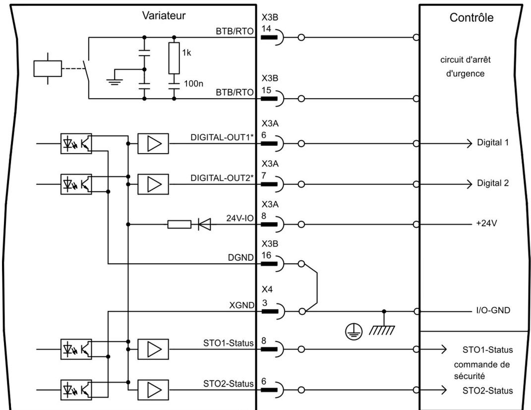
\* DIGITAL-OUT1 et 2 doivent être définies comme sorties à l'aide du logiciel de mise en service.
