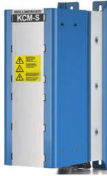
Les modules **KCM (KOLLMORGEN Capacitor Module)** absorbent l'énergie cinétique produite par le moteur en mode générateur. Normalement, cette énergie est transformée en puissance dissipée via les résistances de freinage. Les modules KCM réinjectent l'énergie stockée dans le circuit intermédiaire dès que c'est nécessaire.
