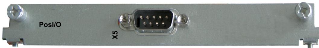
La carte d'expansion met un connecteur mâle SubD X5 à disposition avec entrées et sorties numériques 5 V bidirectionnelles rapides. A l'aide du logiciel de mise en service, il est possible de présélectionner différentes fonctions d'entrée et de sortie, p. ex. :
