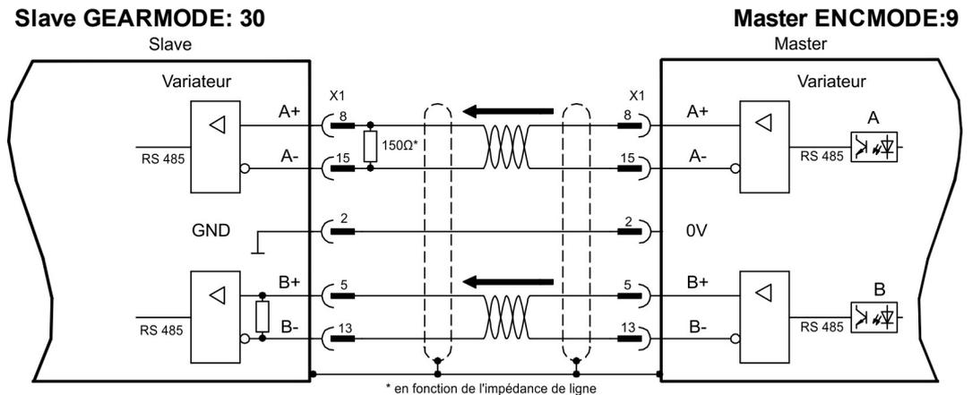
Si un SSI est utilisé comme émulation, le paramètre ENCMODE 10 doit être défini sur le maître et GEARMODE 25 sur l'esclave.
