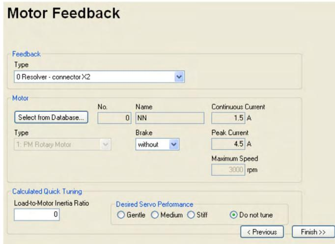
Paramétrage simplifié des paramètres du moteur.
