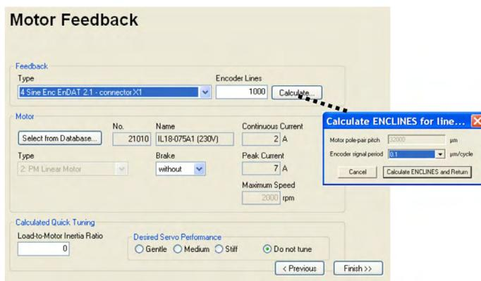
Paramétrage simplifié des paramètres du moteur.
