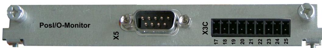
La carte d'expansion met à disposition outre X5, le connecteur mâle X3C avec entrées et sorties analogiques +/-10 V (reportez-vous (→ # 152), chapitre "E/S analogiques"), dont les fonctions peuvent être configurées à l'aide du logiciel de mise en service ou de macrofonctions.
