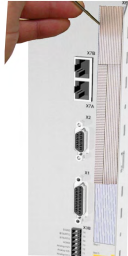
2 - Folie lösen (Perforierung)
