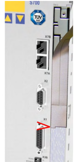
3 - Folie abreißen (bis zur Markierung)
