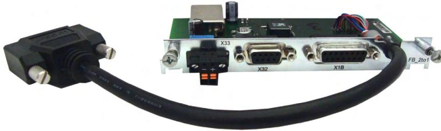
Ce chapitre décrit la carte d'expansion de rétroaction FB-2to1. Cette carte permet de raccorder simultanément un système de feedback primaire numérique et un système de feedback secondaire analogique au connecteur X1. L'alimentation d'une tension auxiliaire de 24 V DC sur X33 est convertie sur la carte d'expansion en une alimentation de codeur précise de 5 V CC pour le feedback secondaire.
