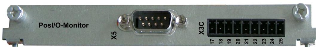
La carte d'expansion met à disposition outre X5, le connecteur mâle X3C avec entrées et sorties analogiques +/-10 V (reportez-vous (→ # 158), chapitre "E/S analogiques"), dont les fonctions peuvent être configurées à l'aide du logiciel de mise en service ou de macro-fonctions.
