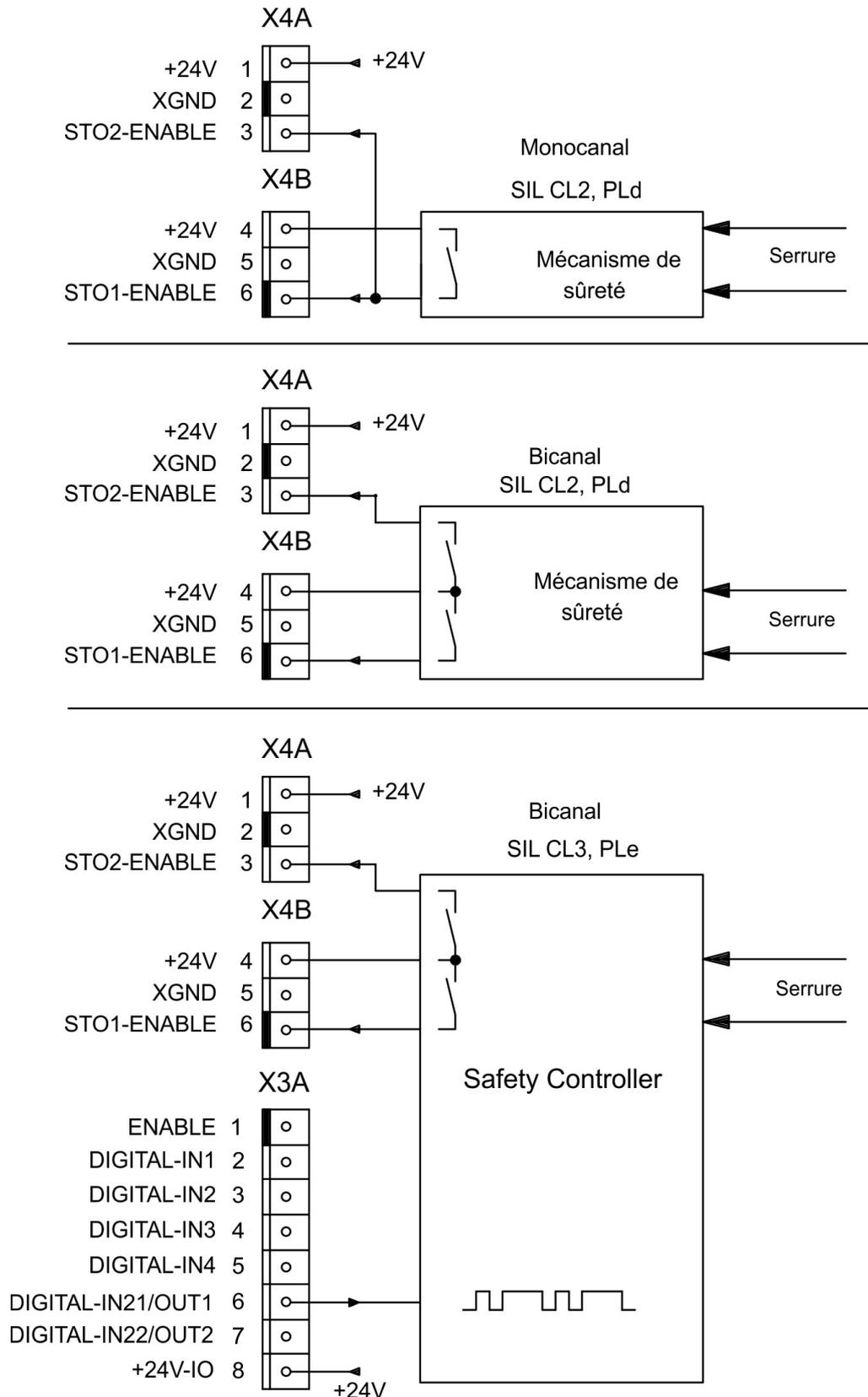
**INFORMATION** Pour atteindre SIL CL3 / PLe, l'état de commutation du blocage d'impulsions (état) est défini sur l'une des sorties numériques DIGITAL-OUT1 ou 2 (X3A/6 ou X3A/7) du variateur S700 à l'aide de la commande ASCII OxMODE 70.
