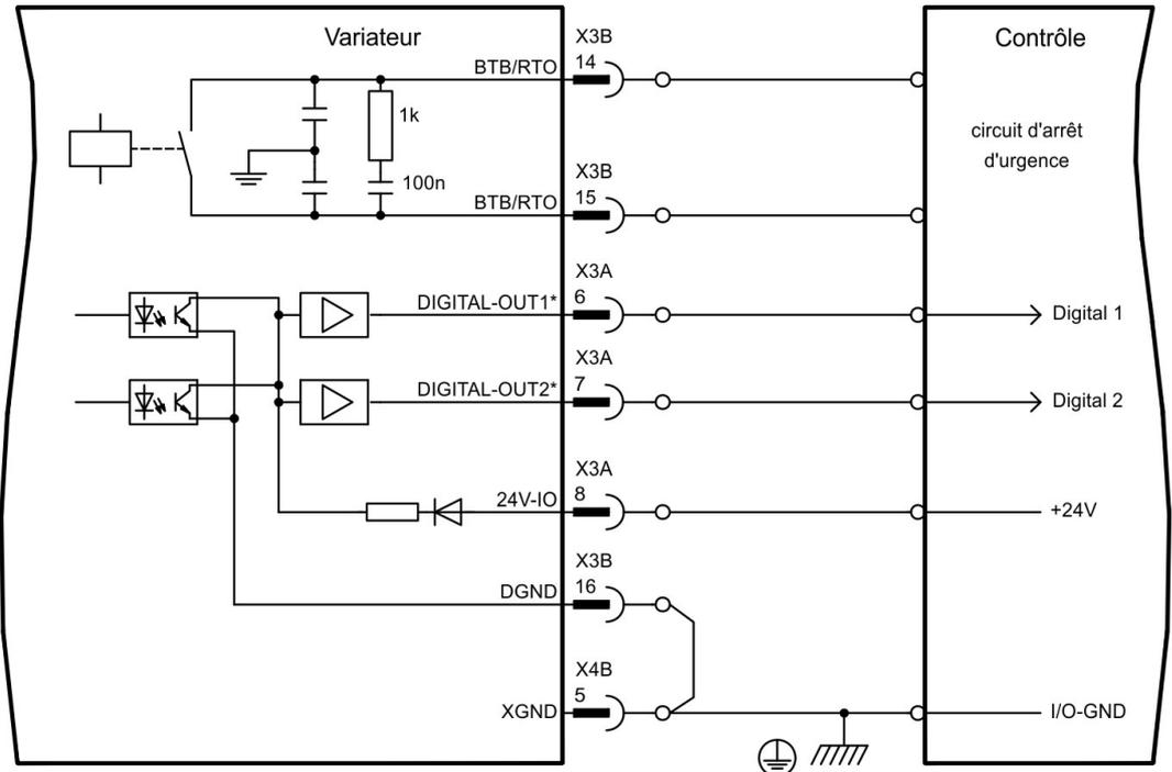
\* DIGITAL-OUT1 et 2 doivent être définies comme sorties à l'aide du logiciel de mise en service.
