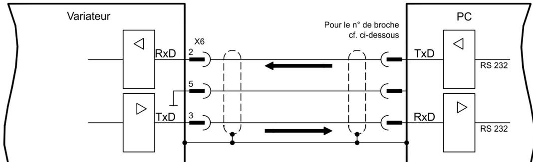
L'interface, isolée galvaniquement via des coupleurs optoélectriques, est placée au même potentiel que l'interface CANopen. L'interface est sélectionnée et réglée dans le logiciel setup. Vous trouvez d'autres indications page (→ # 111).
