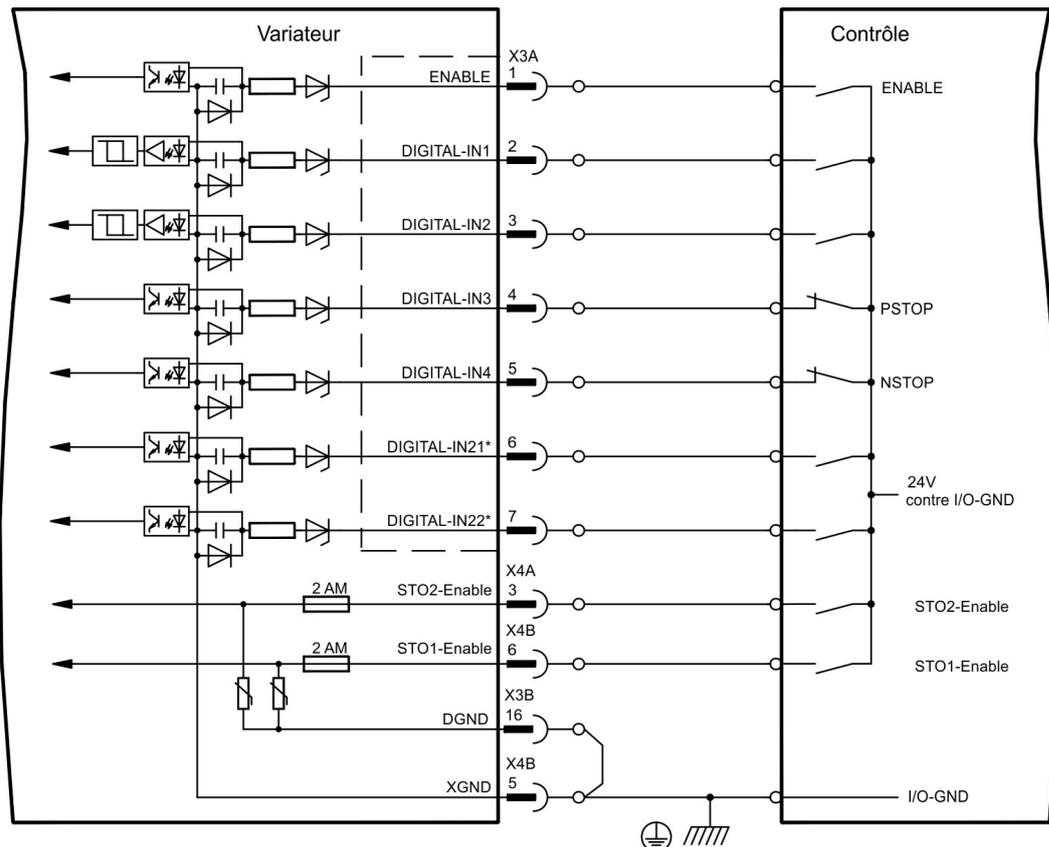
\* Les entrées DIGITAL-IN21 et 22 doivent être définies comme entrées à l'aide du logiciel de mise en service (Page "I/O digital")
