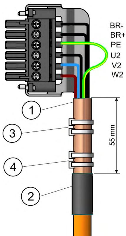
Retirez la gaine extérieure du câble sur une longueur d'env. 120 mm **sans endommager la tresse de blindage**. Enfilez la tresse de blindage (1) sur le câble en sens inverse et fixez-la à l'aide d'un passe-câble en caoutchouc (2) ou d'une gaine thermorétractable.
