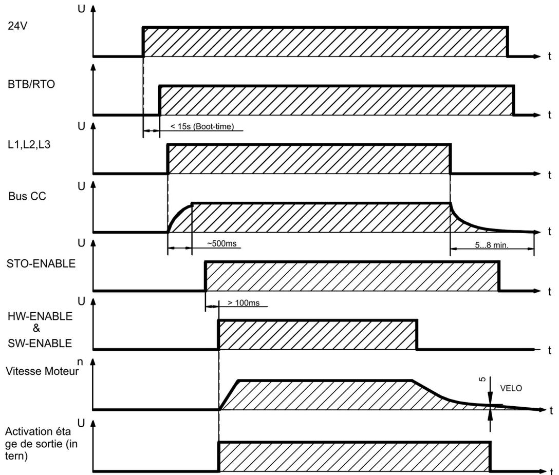
Les appareils avec sélection de la fonction "frein" (d'arrêt) disposent d'une procédure spéciale pour la mise hors service de l'étage final (→ # 34).
