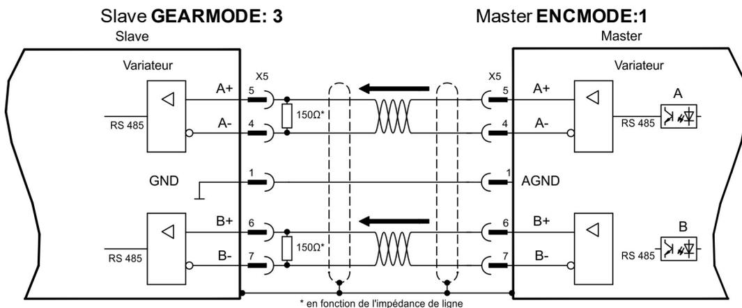
Si un SSI est utilisé comme émulation, le paramètre ENCMODE 2 doit être défini sur le maître et GEARMODE 5 sur l'esclave.
