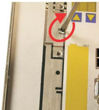
4 - Break the top rib
