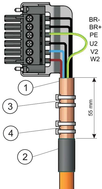
Entfernen Sie die äußere Ummantelung des Kabels auf ca. 120mm Länge **ohne das Schirmgeflecht zu verletzen**. Stülpen Sie das Schirmgeflecht (1) über das Kabel zurück und sichern Sie es mit einer Gummitülle (2) oder mit Schumpfschlauch.
