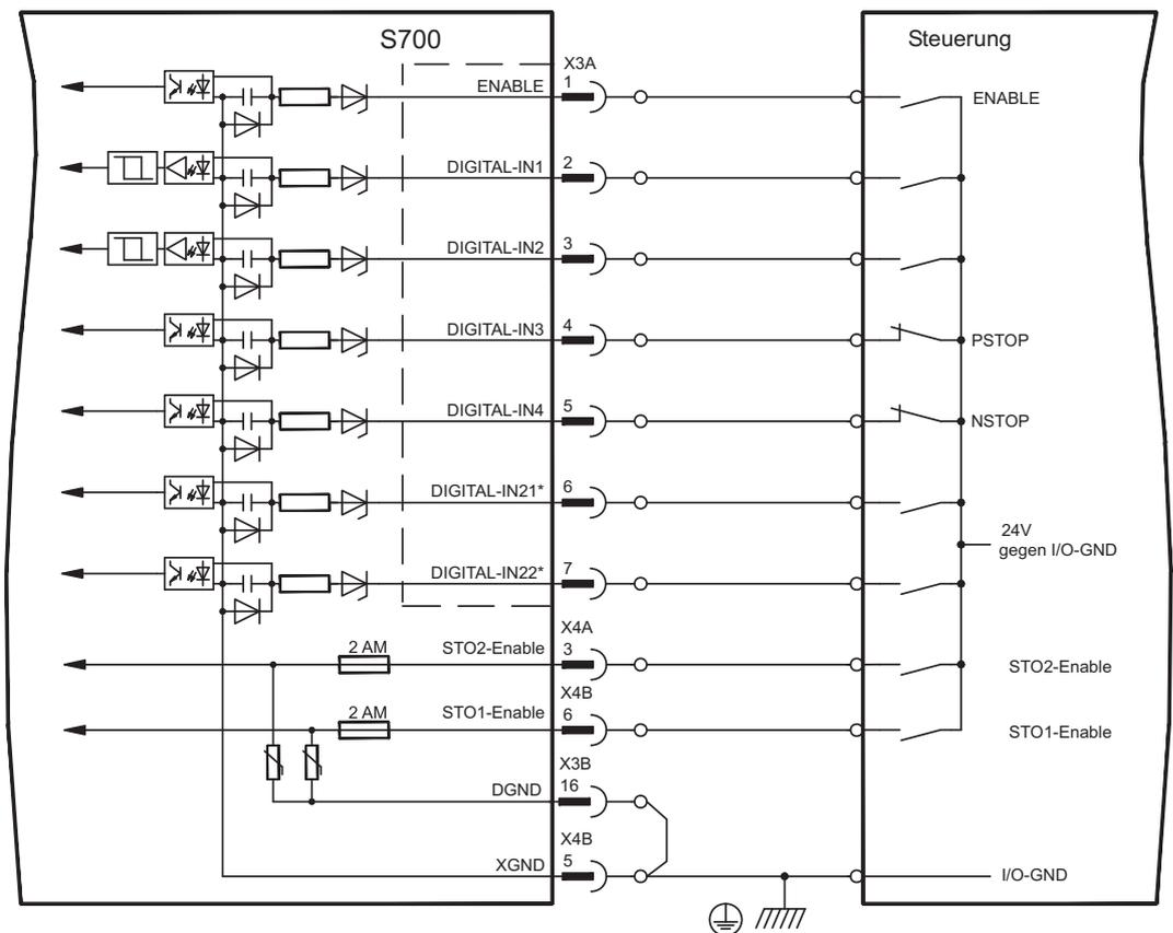
\* DIGITAL-IN21 und 22 müssen mit Hilfe der Inbetriebnahmesoftware als Eingänge definiert werden (Bildschirmseite "I/O digital")
