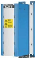
Die **KCM** Module (**KOLLMORGEN** Capacitor **M**odule) nehmen Energie auf, die der Motor im generatorischen Betrieb erzeugt. Normalerweise wird diese Energie über Bremswiderstände in Verlustleistung umgesetzt. Die KCM Module speisen die gespeicherte Energie in den Zwischenkreis zurück, wenn sie benötigt wird. Maße (HxBxT) : 300x100x201 mm
