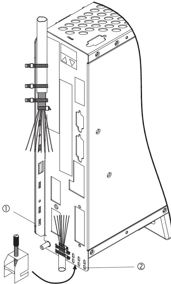
Entfernen Sie die äußere Ummantelung des Kabels und das Schirmgeflecht auf die gewünschte Aderlänge. Sichern Sie die Adern mit einem Kabelbinder.
