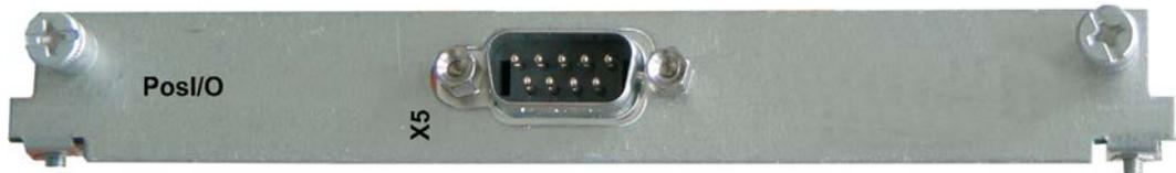
Die Erweiterungskarte stellt einen SubD Stecker X5 zur Verfügung mit schnellen, bidirektionalen digitalen 5V Ein- und Ausgängen. Mit Hilfe der Inbetriebnahmesoftware können verschiedene Ein- und Ausgangsfunktionen vorgewählt werden, z.B.:
