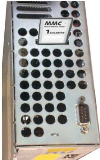
Oben im Servoverstärker befindet sich ein Kartenleser für Speicherkarten. Auf der Speicherkarte kann die Firmware und ein vollständiger Parametersatz abgespeichert werden und wieder in den Servoverstärker geladen werden. MMC und SD Karten werden unterstützt.
