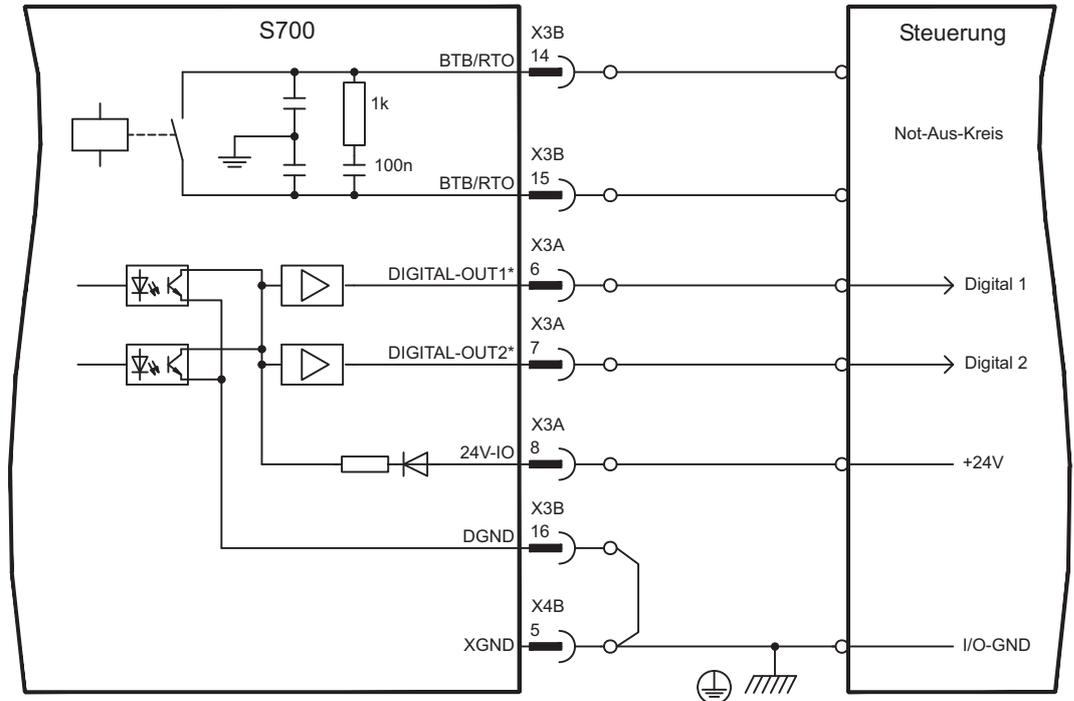
\* DIGITAL-OUT1 und 2 müssen mit Hilfe der Inbetriebnahmesoftware als Ausgänge definiert werden.
