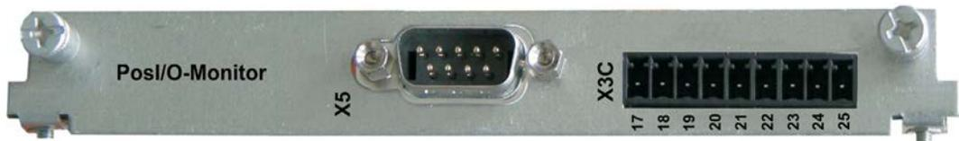
Die Erweiterungskarte stellt zusätzlich zu X5 den Stecker X3C zur Verfügung mit analogen +/-10V Ein- und Ausgängen (siehe Seite 150, Kapitel "Analoge I/O"), deren Funktion mit der Inbetriebnahmesoftware bzw. Makrofunktionen eingestellt werden kann.
