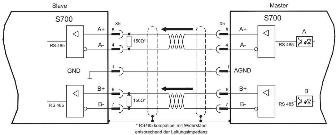
Wenn als Emulation SSI verwendet würde, müsste beim Master ENCMODE 2 und beim Slave GEARMODE 5 eingestellt werden.
