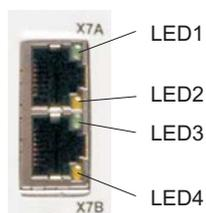
Der Zustand der Kommunikation wird über die integrierten LEDs gemeldet.
