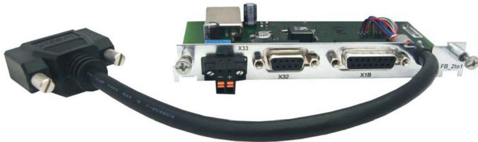
Dieses Kapitel beschreibt die Feedback Erweiterungskarte FB-2to1 für den S700. Die Karte ermöglicht den gleichzeitigen Anschluss eines digitalen primären und eines analogen sekundären Feedbacks an den Stecker X1. Die Einspeisung einer 24V DC Hilfsspannung an X33 wird auf der Erweiterungskarte in eine präzise 5V DC Geberversorgung für das sekundäre Feedback gewandelt.
