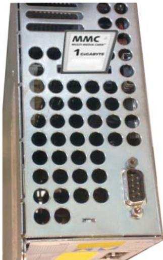
Oben im Servoverstärker befindet sich ein Kartenleser für Speicherkarten. Auf der Speicherkarte kann die Firmware und ein vollständiger Parametersatz abgespeichert werden und wieder in den Servoverstärker geladen werden. Es werden MMC und SD Karten unterstützt.
