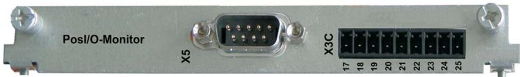
Die Erweiterungskarte stellt einen zusätzlichen Stecker X3C zur Verfügung mit analogen +/-10V Ein- und Ausgängen (siehe Seite 129, Kapitel "Analoge I/O"), deren Funktion mit der Inbetriebnahmesoftware bzw. Makrofunktionen eingestellt werden kann.
