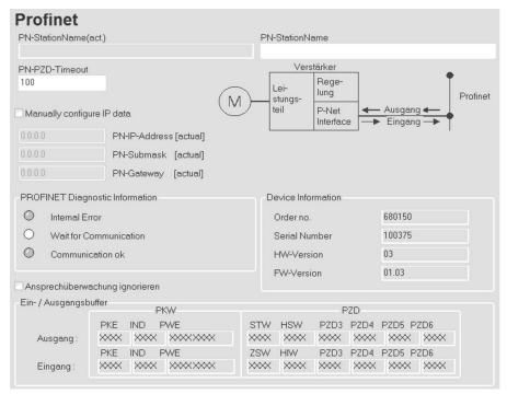
PN-Stationsname Der aktuelle Name des Gerätes wird links angezeigt, rechts ist ein Ein-
