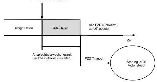
Der Motor läuft danach nicht mehr selbständig an. Es muss erneut ein Nulltelegramm geschickt werden, bzw. PROFINET neu initialisiert werden.
