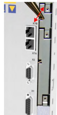
6 - Blech oben ausbrechen
