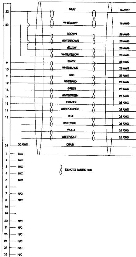
Figure B.10 J2 to No Connector Encoder Cable (P/N 401-34424)
