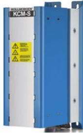
I moduli **KCM** (**K**OLL**M**ORGEN **C**apacitor **M**odules) assorbono energia cinetica generata dal motore in modalità generatore. Di regola questa energia viene convertita in potenza dissipata attraverso resistenze di frenatura esterne. I moduli alimentano l'energia accumulata al circuito DC-link, quando è necessario.
