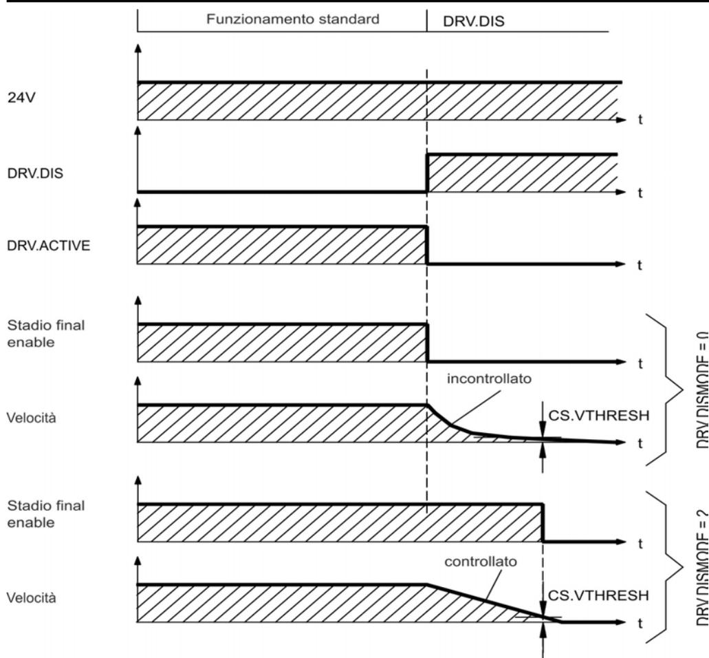
Se la velocità scende al di sotto della soglia *CS.VTHRESH* o se si verifica un timeout nel corso di una procedura di arresto, il freno viene chiuso (→ p. 105).
