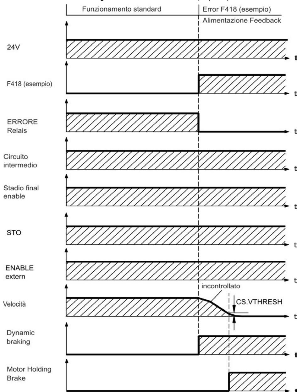
Se la velocità scende al di sotto della soglia *CS.VTHRESH* o se si verifica un timeout nel corso di una procedura di arresto, il freno viene chiuso (→ p. 105).
