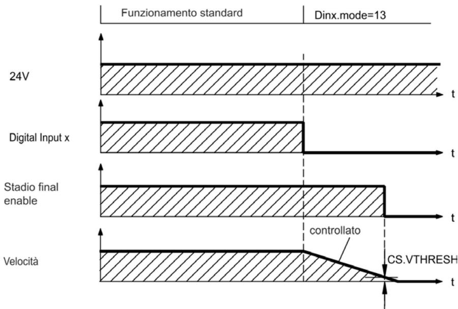
Se la velocità scende al di sotto della soglia  $CS.VTHRESH$  o se si verifica un timeout nel corso di una procedura di arresto, il freno viene chiuso (→ p. 105).
