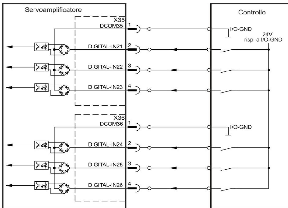
**Schema dei collegamenti degli ingressi digitali (collegamento di tipo sink, esempio)**
