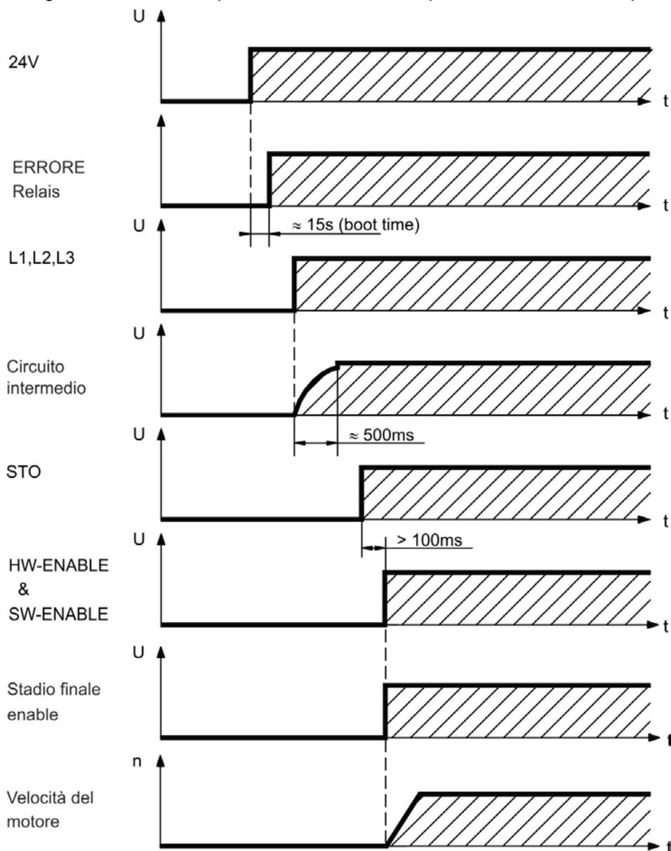
Si verifica l'errore F602 quando la STO non ha corrente nel momento in cui il comando di abilitazione dell'hardware (HW enable) diventa attivo (→ p. 54 per ulteriori informazioni sulla funzione STO).
