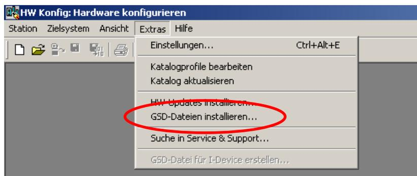
**Bild 5:** SIMATIC HW Konfig mit Menü „GSD-Dateien installieren“
