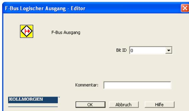
Mit „Bit ID“ kann die Bitstelle im FSoE Daten Telegramm bestimmt werden.
