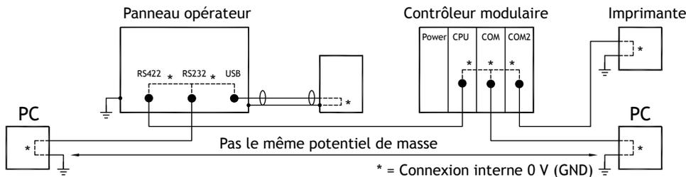
Quand un PC est connecté au panneau HMI, la tension interne de 0 V (GND) du panneau est connectée à la terre de protection via le PC.
