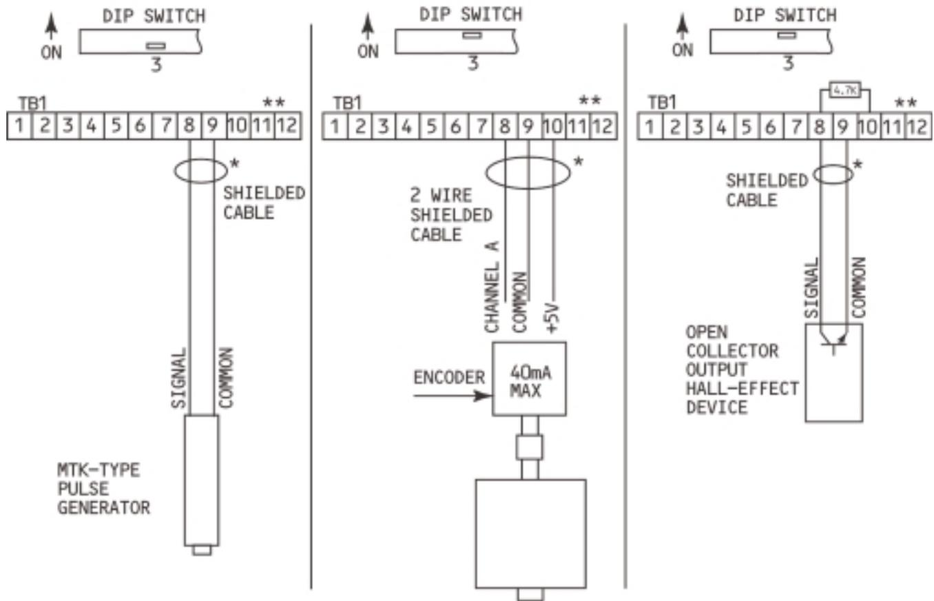
\* TO ELIMINATE NOISE INTERFERENCE SHIELDED CABLE SHOULD BE USED FOR LOW LEVEL SIGNALS. CONNECT THE SHIELD TO THE DS9000 GROUND CONNECTION.
