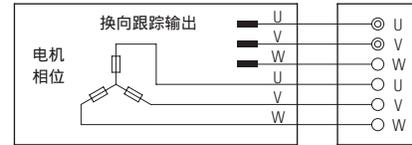
换向输出：开集电极W2.2 K欧姆，外部上拉电路（漏电流最大8 mA）
