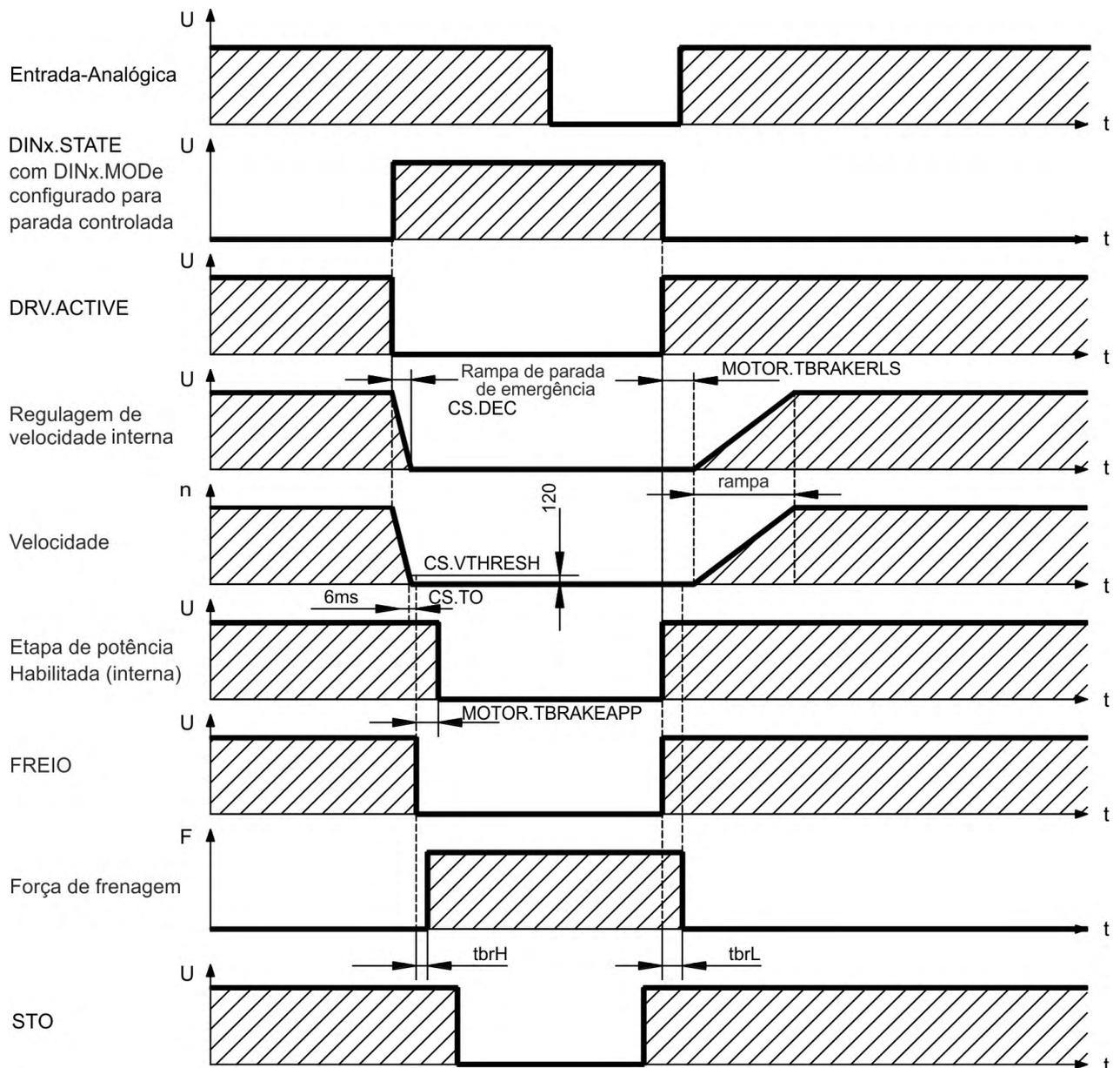
A regulagem da velocidade do drive é conduzido internamente à uma rampa ajustável (CS.DEC) para 0 V.
