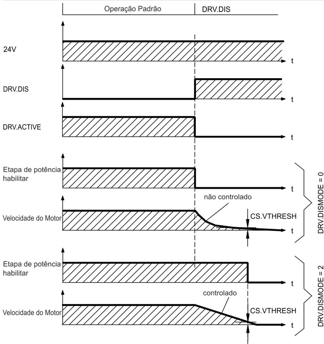
Se a velocidade ficar abaixo do limiar *CS.VTHRESH* ou esgotar o tempo, o freio é aplicado (→ # 119).
