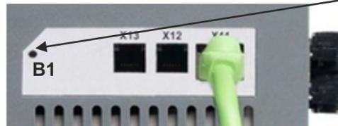
O display exibe **En** durante o processo de alteração do DRV.TYPE para EtherCAT. **Não desligue a fonte de alimentação de 24[V] enquanto o display mostrar En!**
