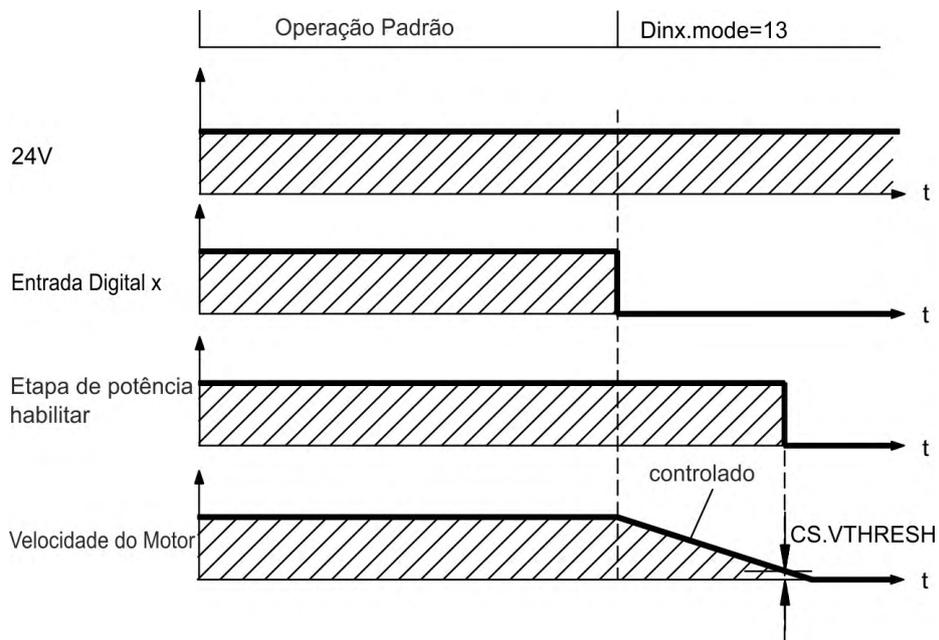
Se a velocidade ficar abaixo do limiar *CS.VTHRESH* ou esgotar o tempo, o freio é aplicado (→ # 119).
