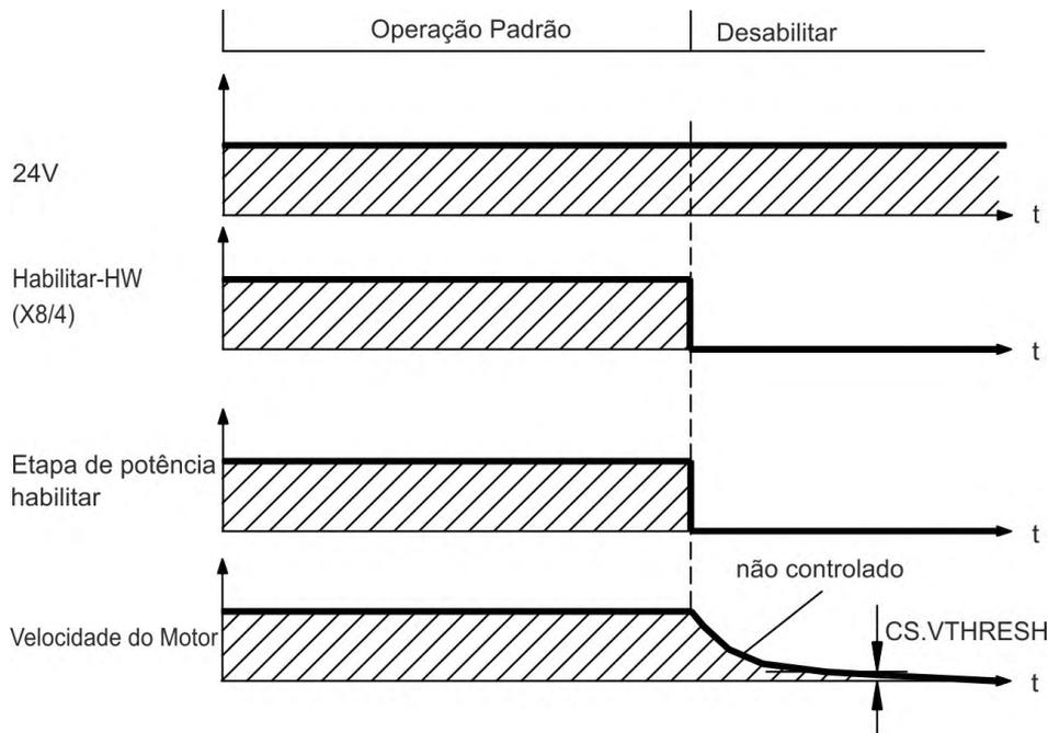
Se a velocidade fica abaixo do limiar *CS.VTHRESH* ou esgotar o tempo o freio de retenção do motor é aplicado (→ # 119). Defina o parâmetro *MOTOR.BRAKEIMM* para 1 com eixos verticais, para aplicar o freio de retenção do motor imediatamente após Desabilitar o Hardware.
