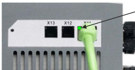
O LED fica verde se o drive estiver conectado através de um dispositivo de rede.
