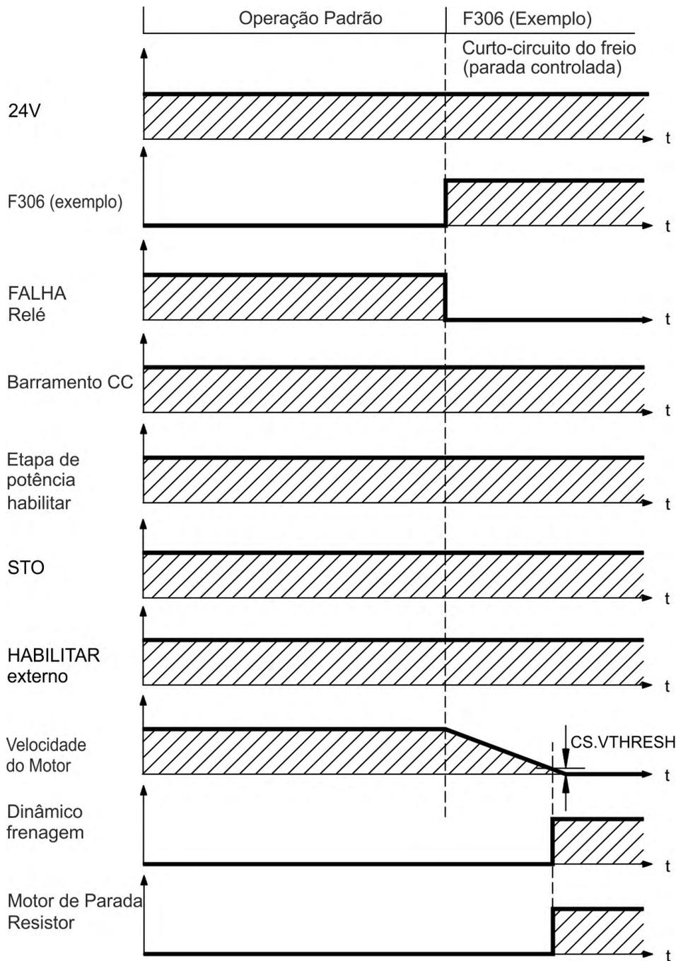
Se a velocidade ficar abaixo do limiar  $CS.VTHRESH$  ou esgotar o tempo, o freio é aplicado (→ # 119).
