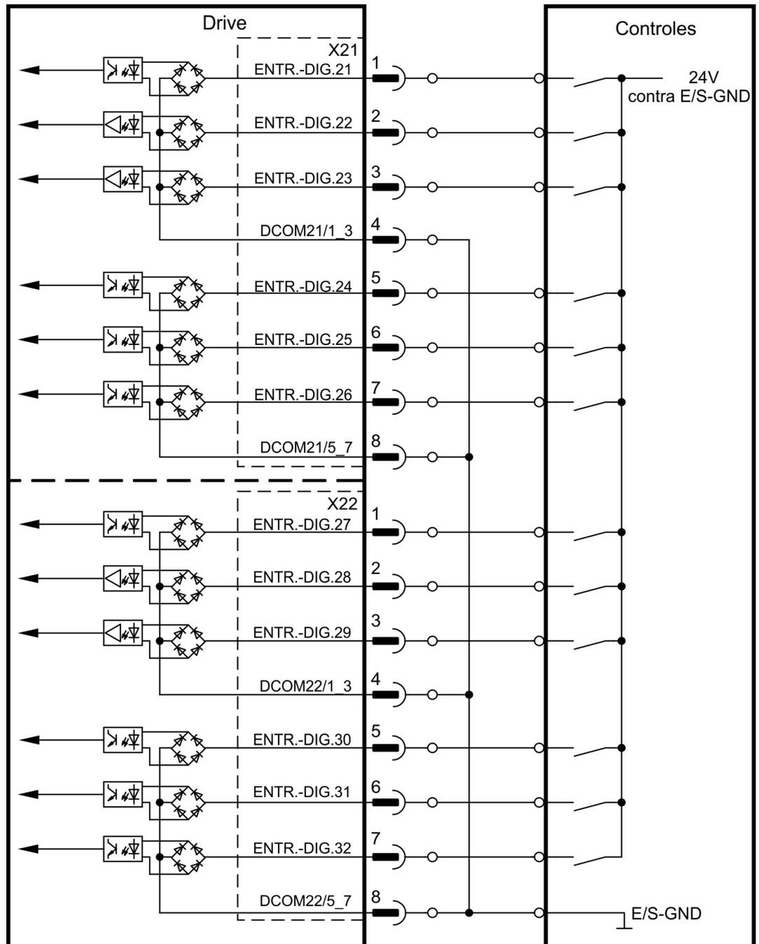
Diagrama de fiação de entrada digital (exemplo de conexão do tipo source)
