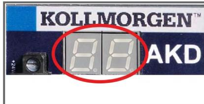
Se presente, os códigos de falha ou de advertência do AKD são exibidos constantemente. As mensagens de falha são codificadas com "F", e os avisos com "n". Com cartão de opção de E/S integrado, erros de operação do cartão SD são exibidos com um "E" seguido de 4 dígitos..
