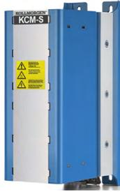
Os módulos KCM (**K**OLL**M**ORGEN **M**ódulos **C**apacitores) absorvem a energia cinética gerado pelo motor quando estiver funcionando no modo gerador. Normalmente, essa energia é dissipada como desperdício por meio de resistores de regeneração. No entanto, os módulos KCM alimentam a energia que possuem armazenada de volta para o link de barramento DC conforme e quando for necessário.
