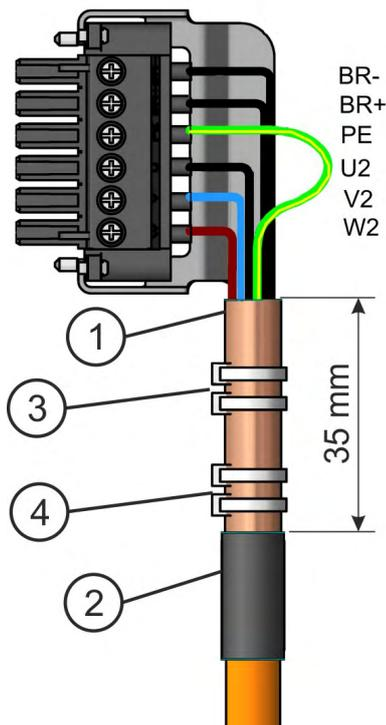
Descape o cabo externo em, aproximadamente, 120 mm, tomando cuidado para não danificar a blindagem trançada. Empurre para trás a blindagem trançada (1) sobre o cabo e fixe-a com uma luva de borracha (2) ou retrátil.
