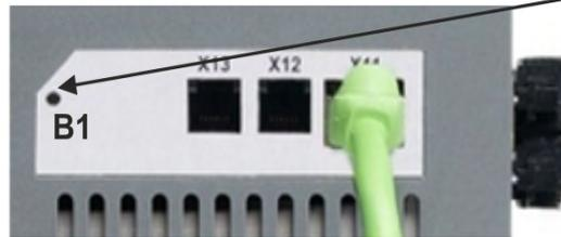
O display exibe **Cn** durante o processo de alteração do DRV.TYPE para CAN.
