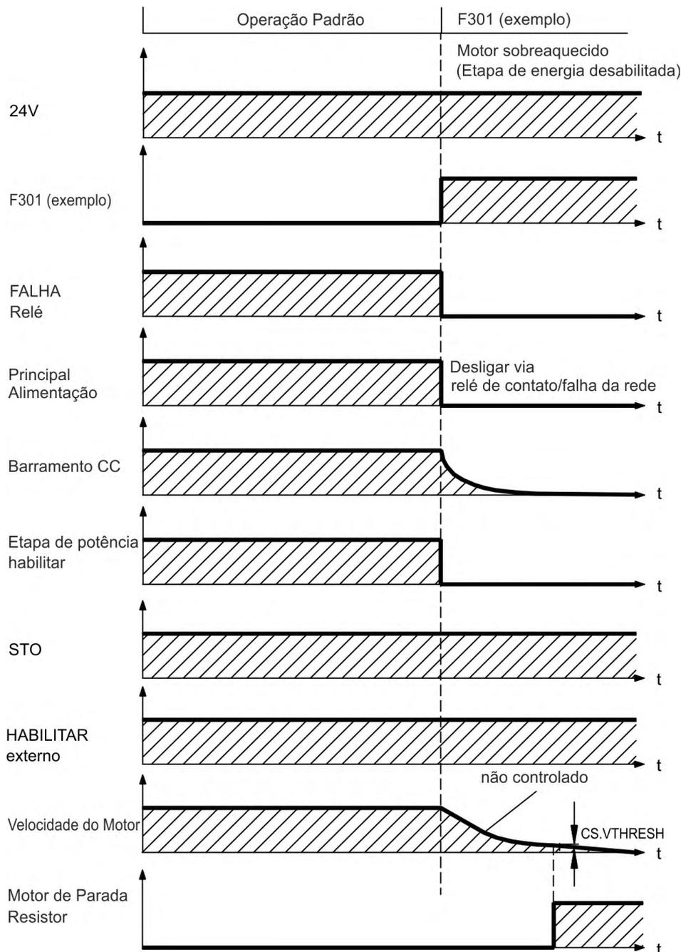
Se a velocidade fica abaixo do limiar  $CS.VTHRESH$  ou esgotar o tempo, o freio de retenção do motor é aplicado (→ # 119). Defina o parâmetro  $MOTOR.BRAKEIMM$  para 1 com eixos verticais, para aplicar o freio de retenção do motor imediatamente após as falhas.
