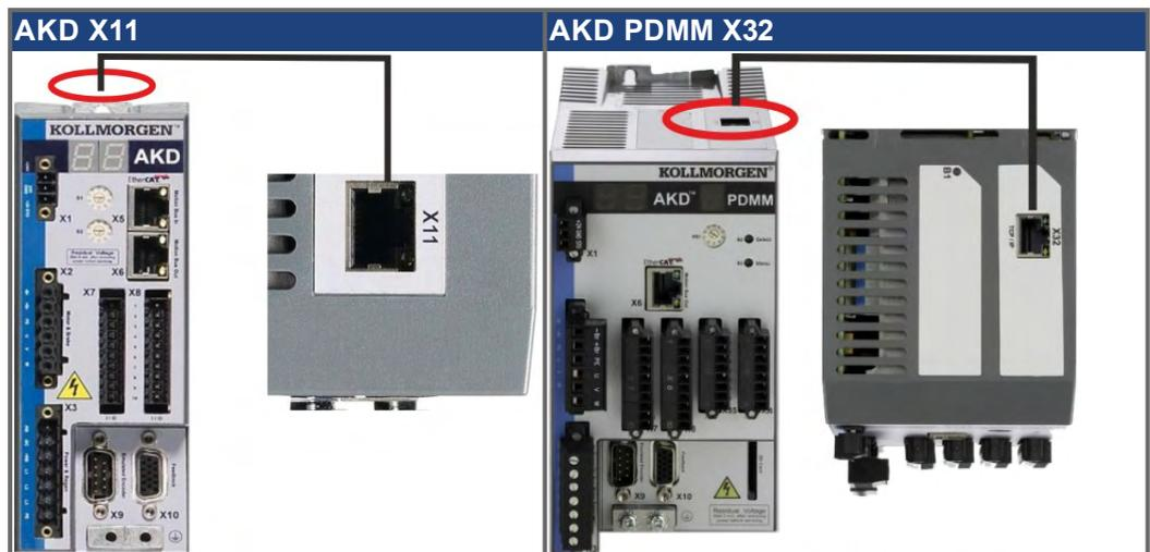
Conecte a interface de serviço (X11 ou X32) do drive para uma interface Ethernet no PC diretamente ou através de um(a) hub/central de rede, **enquanto a alimentação para o equipamento estiver desligada**. Use cabos Cat. 5 Ethernet padrão para a conexão (em alguns casos cabos cruzados também irão funcionar).
