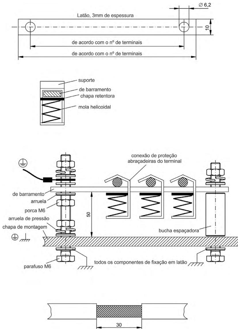
1. Corte um barramento de um tri-lho de latão no comprimento necessário (seção transversal 10 x 3 mm) e perfure orifícios conforme indicado. Todas as abraçadeiras da blindagem necessárias devem se encaixar entre os orifícios perfurados.
