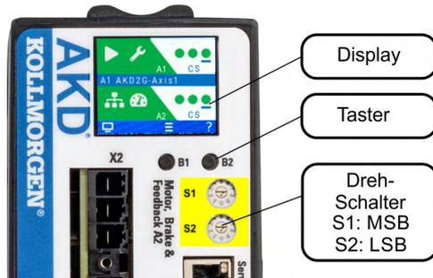
In der Anzeige an der Frontplatte des Verstärkers wird die Nummer des aufgetretenen Fehlers angezeigt. Safety Fehler und Warnungen haben die gleiche 4-stellige Kodierung 90XX, dabei ist 90 ein 2-stelliger Gruppencode und XX eine zweistellige ID.
