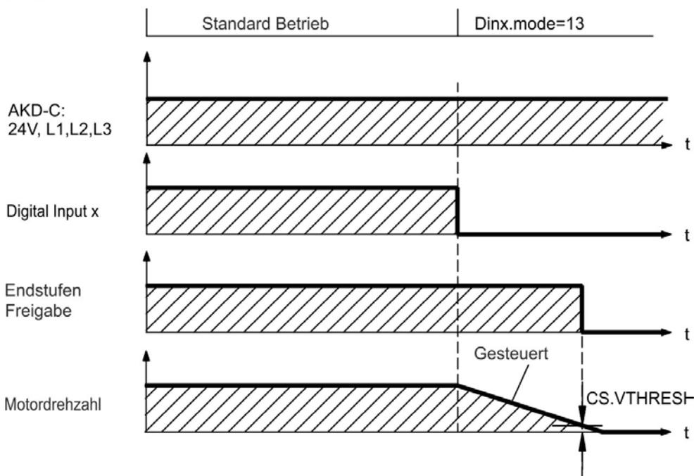
Die Bremse fällt ein, wenn die Geschwindigkeit unter die Schwelle  $CS.VTHRESH$  absinkt oder die Wartezeit  $CS.TO$  abgelaufen ist.
