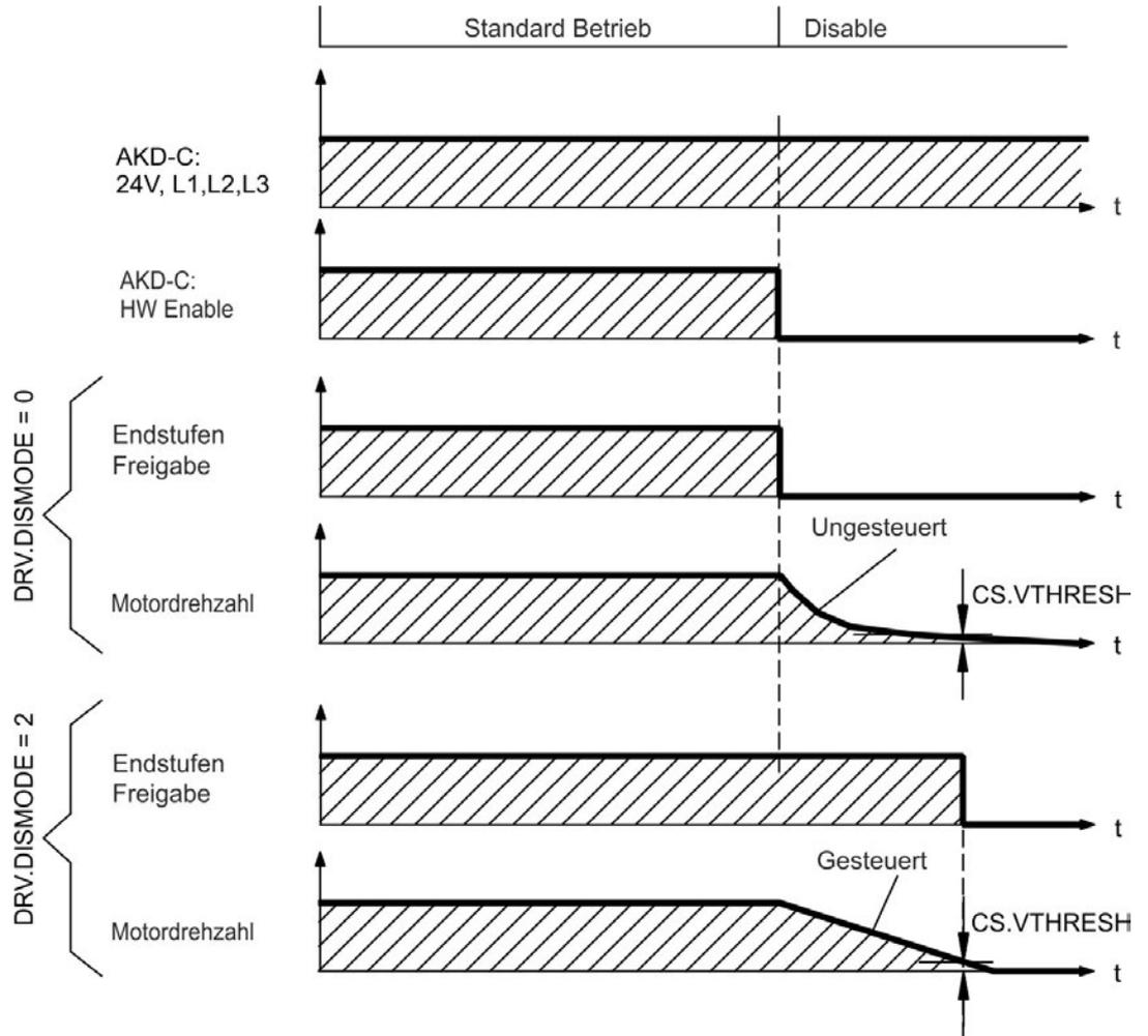
Die Bremse fällt ein, wenn die Geschwindigkeit unter die Schwelle **CS.VTHRESH** absinkt oder die Wartezeit **CS.TO** abgelaufen ist. Setzen Sie bei vertikalen Achsen den Parameter **MOTOR.BRAKEIMM** auf 1, damit die Motorhaltebremse nach Hardware Disable ohne Verzögerung einfällt.
