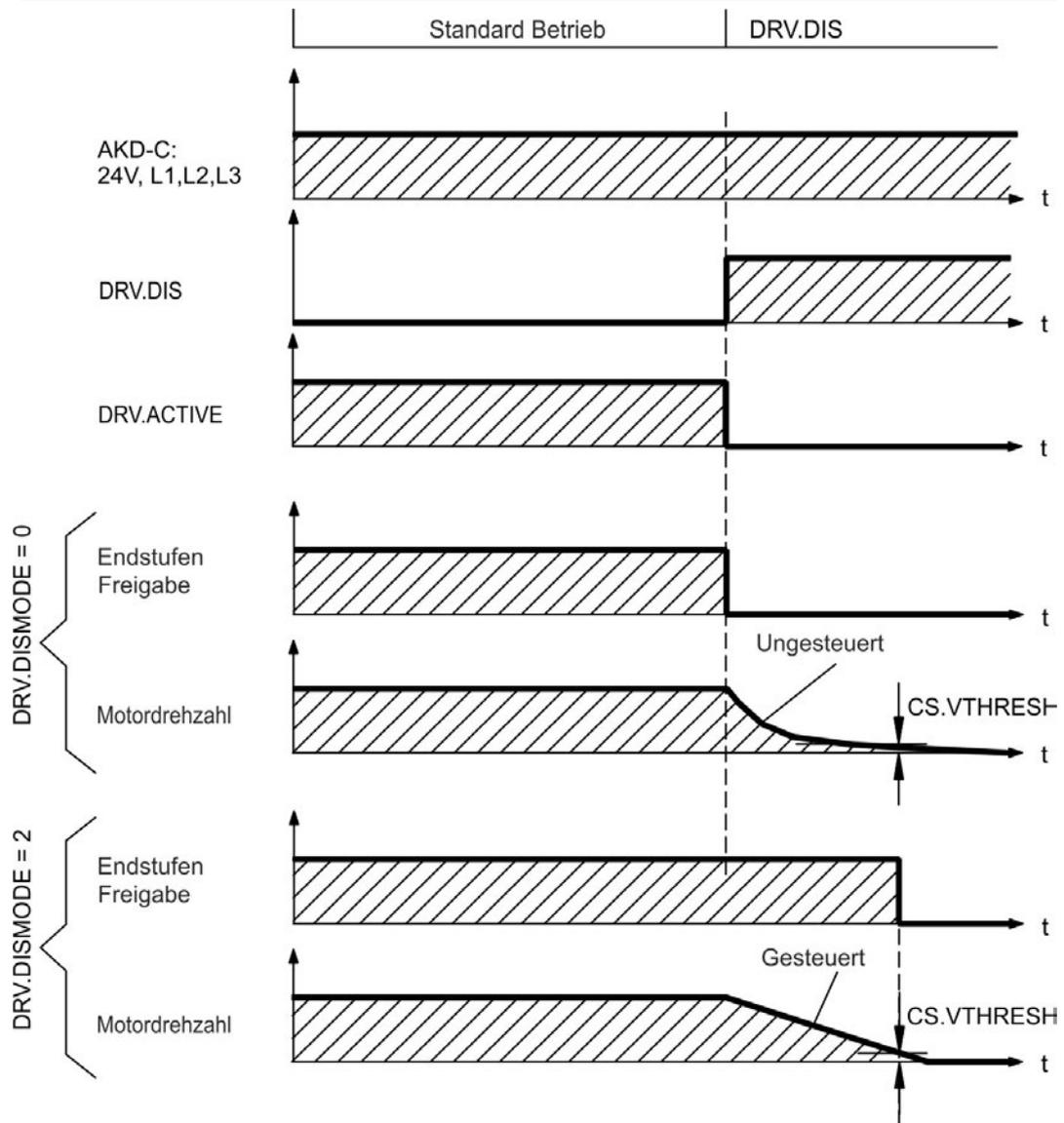
Die Bremse fällt ein, wenn die Geschwindigkeit unter die Schwelle *CS.VTHRESH* absinkt oder die Wartezeit *CS.TO* abgelaufen ist.
