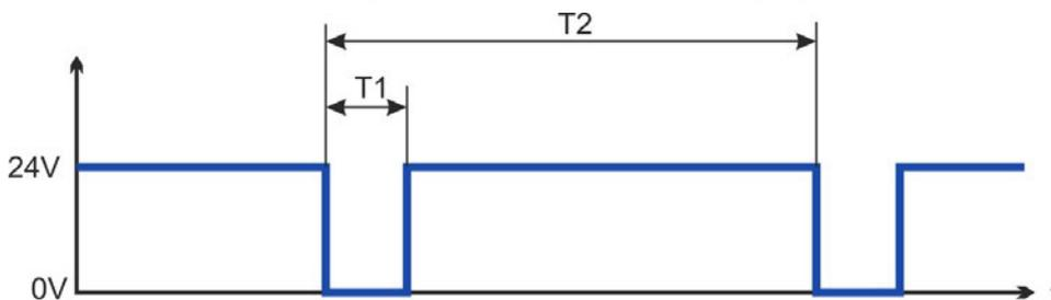
Testpulse mit  $T1 < 300 \mu s$  und  $T2 > 200 ms$  haben keinen Einfluss auf die sicherheitsrelevante STO Funktion. Testpulse außerhalb dieser Spezifikation lösen die STO Funktion aus, führen aber nicht zu einer gefährlichen Situation.
