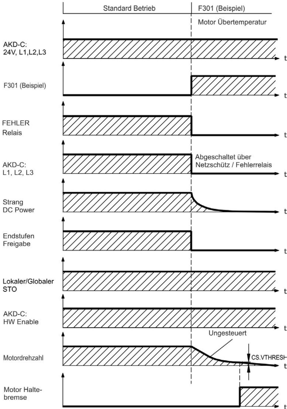
Die Bremse fällt ein, wenn die Geschwindigkeit unter die Schwelle  $CS.VTHRESH$  absinkt oder die Wartezeit  $CS.TO$  abgelaufen ist. Setzen Sie bei vertikalen Achsen den Parameter  $MOTOR.BRAKEIMM$  auf 1, damit die Motorhaltebremse nach Fehler ohne Verzögerung einfällt.
