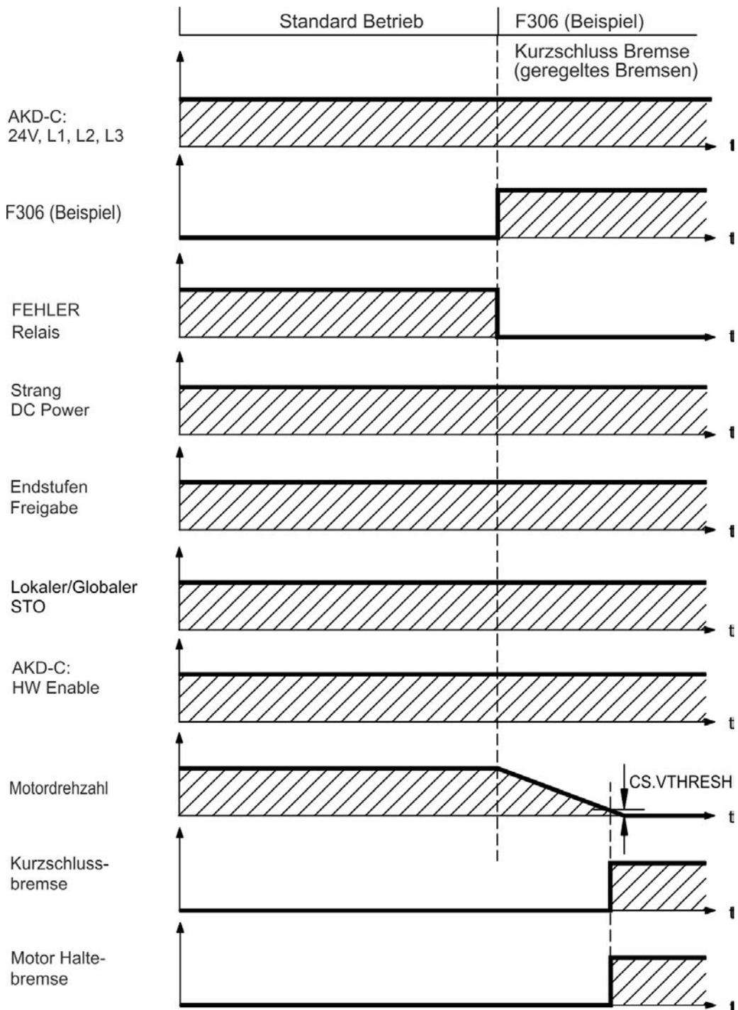
Die Bremse fällt ein, wenn die Geschwindigkeit unter die Schwelle  $CS.VTHRESH$  absinkt oder die Wartezeit  $CS.TO$  abgelaufen ist.
