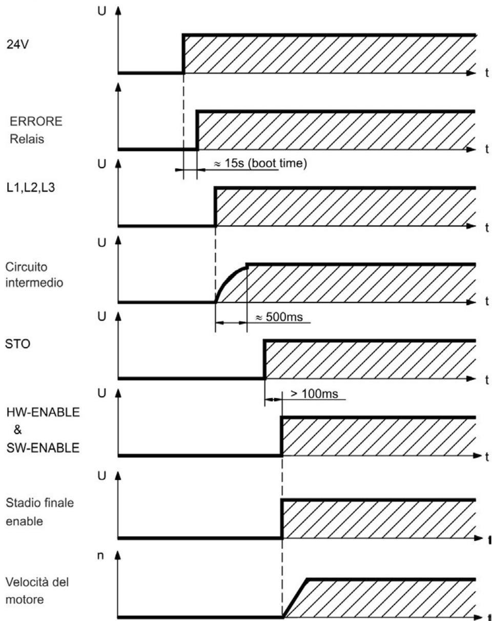
Si verifica l'errore F602 quando la STO non ha corrente nel momento in cui il comando di abilitazione dell'hardware (HW enable) diventa attivo (→ # 55) per ulteriori informazioni sulla funzione STO).
