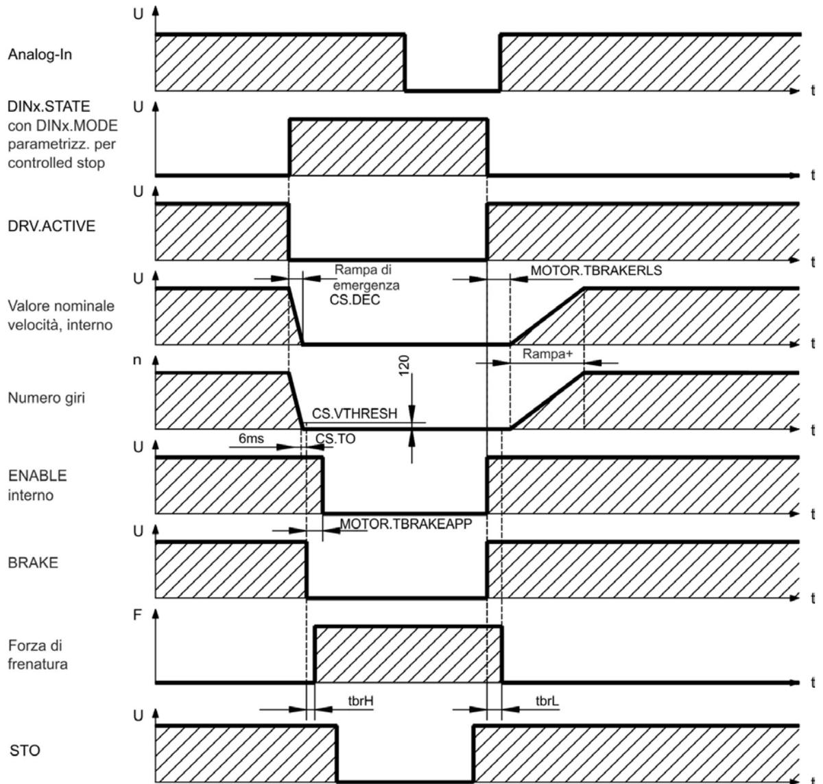
Il setpoint della velocità del servoamplificatore viene abbassato internamente a una rampa regolabile (CS.DEC) di 0 V. Con i valori standard l'uscita per il freno viene attivata quando la velocità raggiunge 120 giri/min. (CS.VTHRESH) per almeno 6 msec (CS.TO). I tempi di aumento ( $t_{brH}$ ) e diminuzione ( $t_{brL}$ ) del freno di stazionamento che sono realizzati nel motore sono diversi in base al tipo di motore (vedere manuale del motore).
