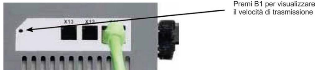
3. quando il display lampeggia con l'impostazione del selettore rotativo, interrompere la pressione sul pulsante B1 e attendere che il lampeggio termini. Durante questo periodo il parametro FBUS.PARAM01 viene impostato al nuovo valore e tutti i parametri vengono memorizzati nella memoria non volatile. La nuova impostazione sarà acquisita all'accensione successiva del servoamplificatore.
