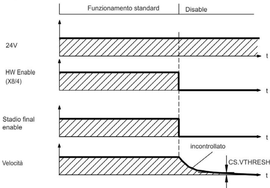
Se la velocità scende al di sotto della soglia *CS.VTHRESH* o se si verifica un timeout nel corso di una procedura di arresto, il freno viene chiuso (→ # 119). Per gli assi verticali impostare il parametro *MOTOR.BRAKEIMM* su 1, affinché in seguito a errori o disabilitazione dell'hardware il freno funzioni senza ritardi.
