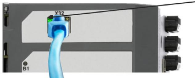
Il LED è verde se l'azionamento è collegato tramite un dispositivo della rete.
