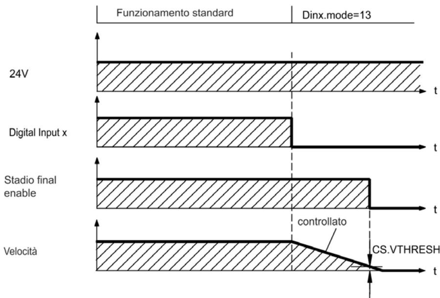
Se la velocità scende al di sotto della soglia *CS.VTHRESH* o se si verifica un timeout nel corso di una procedura di arresto, il freno viene chiuso (→ # 119).
