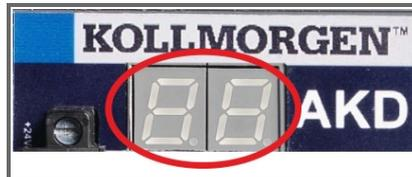
Vengono visualizzati i messaggi di errore o gli allarmi dell'AKD. I messaggi di errore sono codificati con "F", gli allarmi con "n". In caso di scheda I/O opzionale integrata gli errori vengono visualizzati riferiti alla scheda SD con la lettera "E" seguita da 4 numeri
