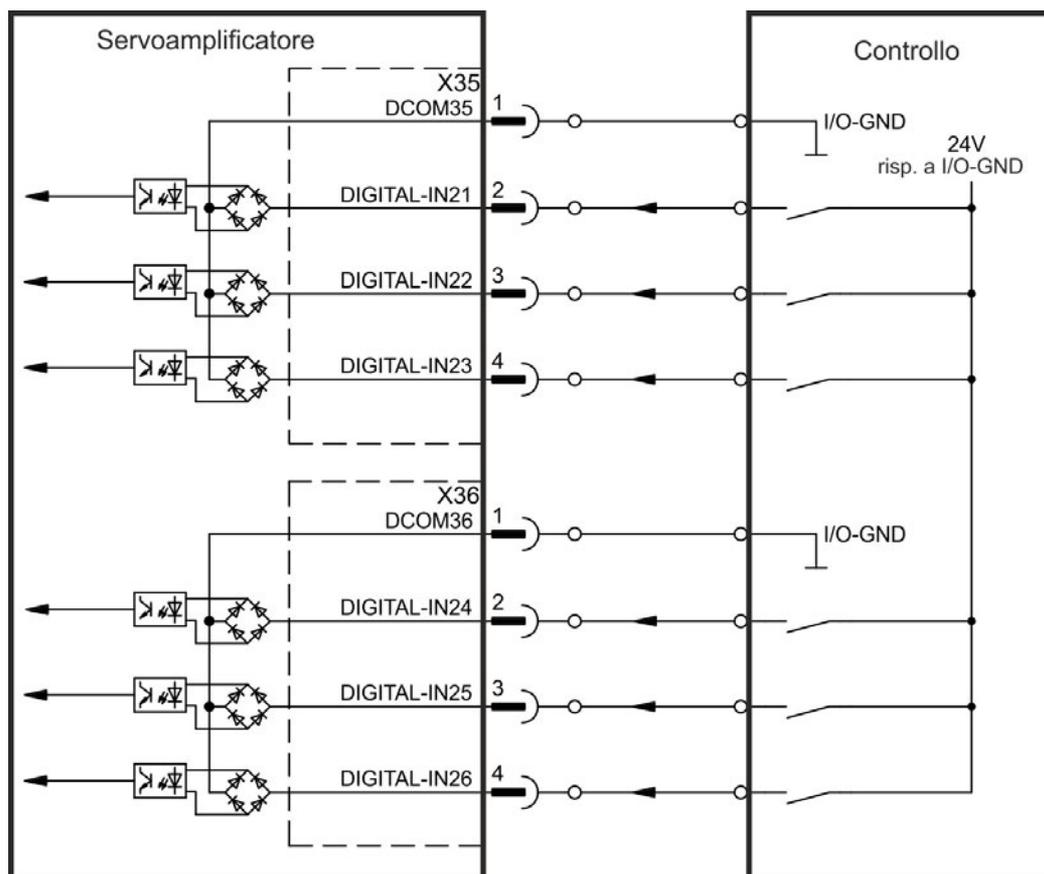
**Schema dei collegamenti degli ingressi digitali (collegamento di tipo sink, esempio)**
