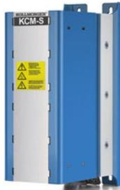
I moduli **KCM** (**KOLLMORGEN Capacitor Modules**) assorbono energia cinetica generata dal motore in modalità generatore. Di regola questa energia viene convertita in potenza dissipata attraverso resistenze di frenatura esterne. I moduli alimentano l'energia accumulata al circuito DC-link, quando è necessario.
