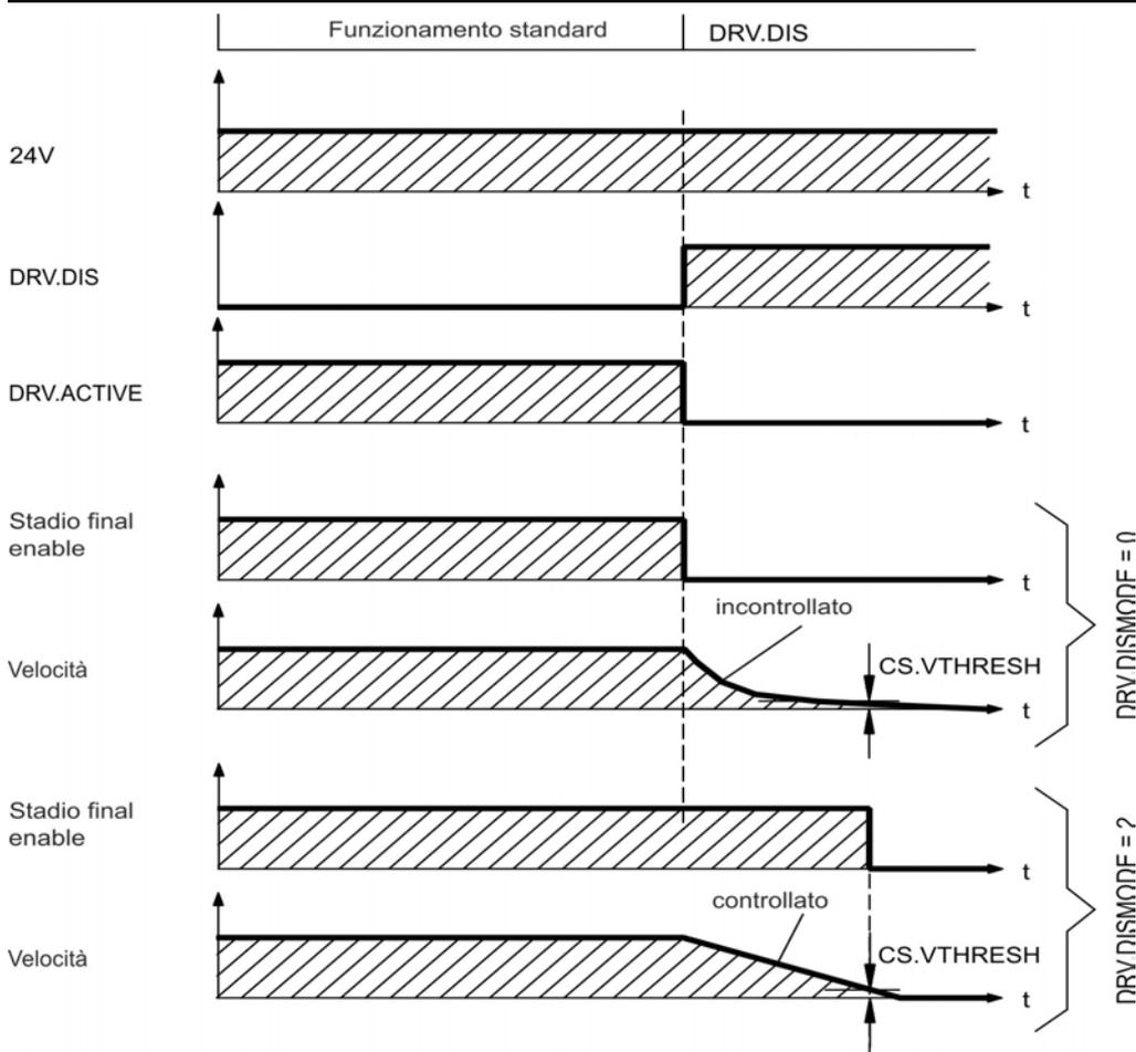
Se la velocità scende al di sotto della soglia *CS.VTHRESH* o se si verifica un timeout nel corso di una procedura di arresto, il freno viene chiuso (→ # 119).
