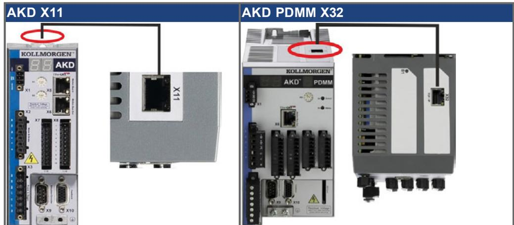
Collegare l'interfaccia di servizio (X11 o X32) del servoamplificatore direttamente a un'interfaccia Ethernet del PC o tramite un hub/switch di rete, **mentre l'alimentazione alle apparecchiature è disattivata**. Usare i cavi Ethernet Cat. 5 per la configurazione del collegamento.
