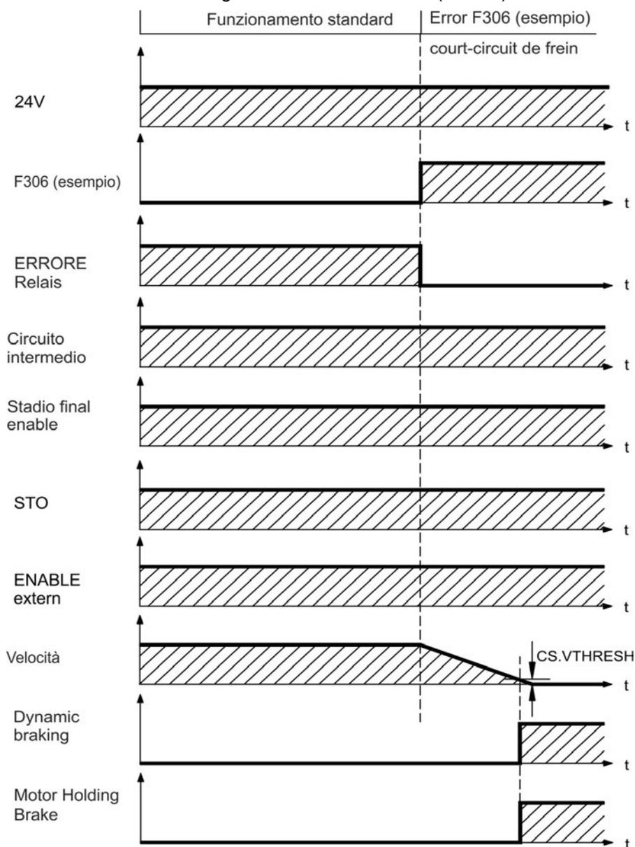
Se la velocità scende al di sotto della soglia  $CS.VTHRESH$  o se si verifica un timeout nel corso di una procedura di arresto, il freno viene chiuso (→ # 119).
