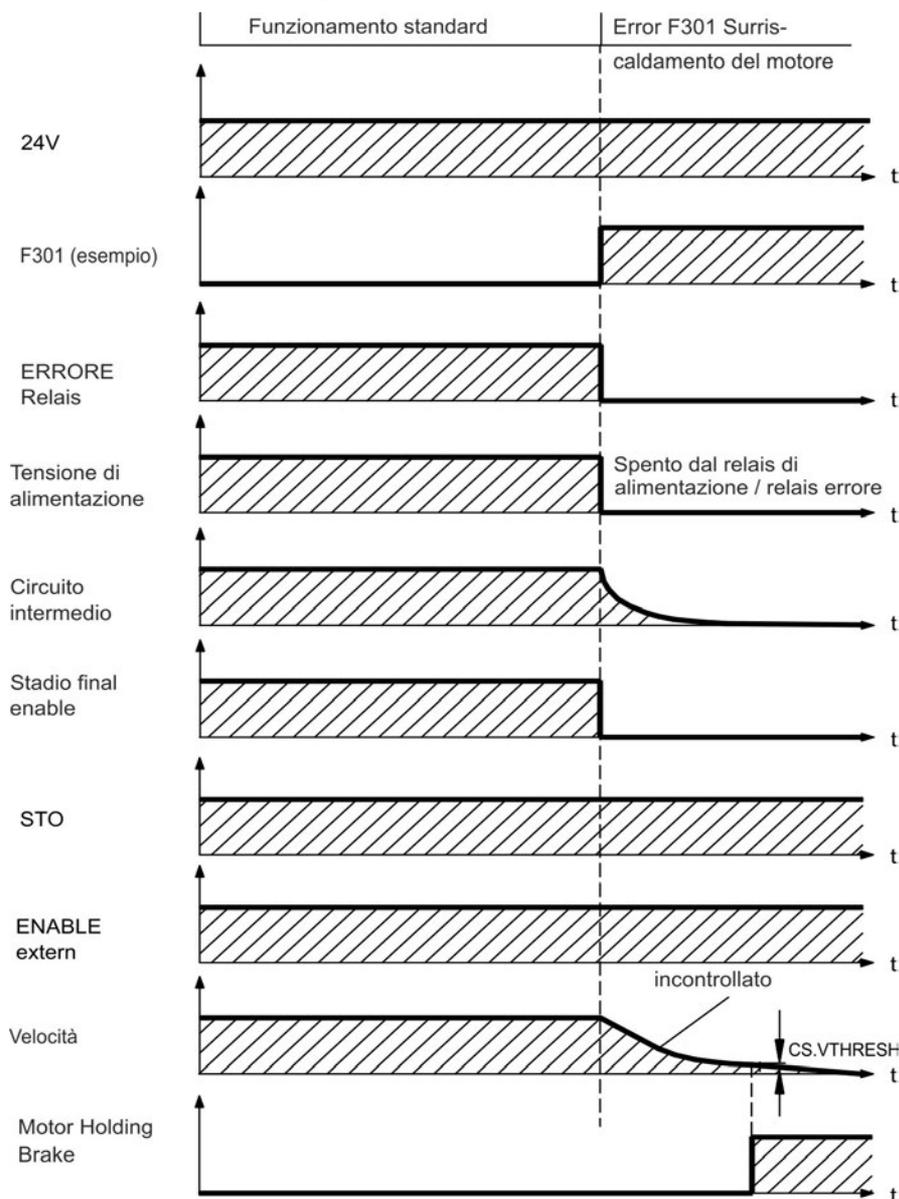
Se la velocità scende al di sotto della soglia  $CS.VTHRESH$  o se si verifica un timeout nel corso di una procedura di arresto, il freno viene chiuso (→ # 119). Per gli assi verticali impostare il parametro MOTOR.BRAKEIMM su 1, affinché in seguito a errori o disabilitazione dell'hardware il freno funzioni senza ritardi.
