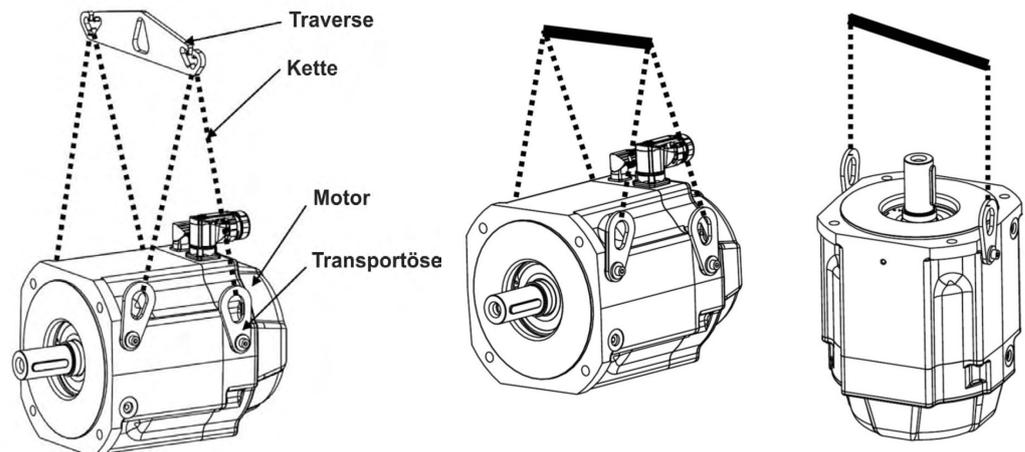
Die Anhängervorrichtung besteht aus einer Traverse, die am Kranhaken eingehängt wird und zwei Kettenanschlüssen. Der Motor kann mit zwei oder vier Kettensträngen befestigt werden. Die Transportösen (Anzahl abhängig vom Motortyp) liegen dem Motor bei.
