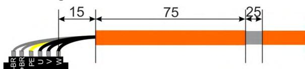
Der Motor wird über einen Combicon Stecker ((→ # 58)) an den AKD-x00306/x00606 angeschlossen. Berücksichtigen Sie, dass der Stecker einen maximalen Aderquerschnitt von 4mm<sup>2</sup> zulässt.
