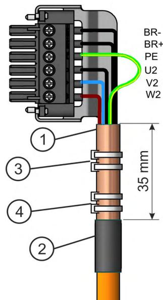
Isolieren Sie die äußere Kabelummantelung auf eine Länge von ca. 120 mm ab und achten Sie darauf, das Schirmgeflecht nicht zu beschädigen. Schieben Sie das Schirmgeflecht (1) über die Leitung und sichern Sie es mit einer Gummhülse (2) oder Schumpfschlauch.
