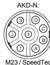
Verwendbar für AKM (Stecker D, Feedback CA, GE, GF). SFD3/DSL und Bremse.
