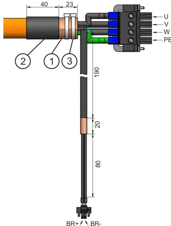
Isolieren Sie die äußere Kabelummantelung auf eine Länge von ca. 300 mm ab und achten Sie darauf, das Schirmgeflecht nicht zu beschädigen. Schieben Sie das Schirmgeflecht (1) über die Leitung und sichern Sie es mit einer Gummhülse (2) oder Schumpfschlauch. Trennen Sie Leistungs- und Bremsadern. Pressen Sie das Schirmgeflecht des Kabels mit Kabelbinder oder Schlauchschellen (3) fest gegen das Schirmblech.
