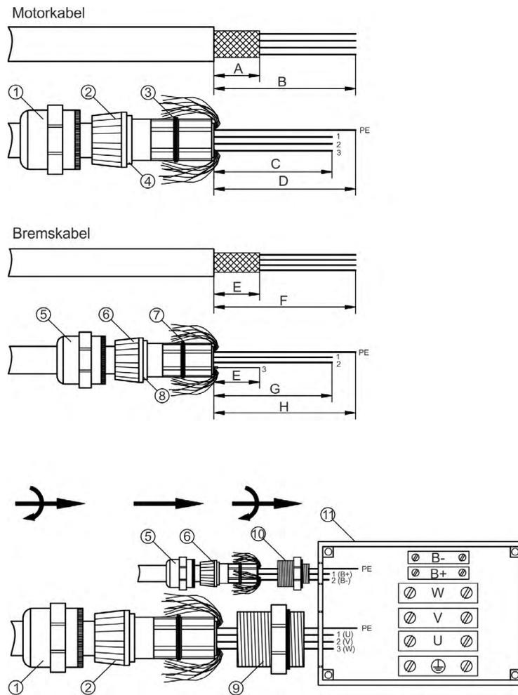
Entfernen Sie die äußere Ummantelung auf Maß B, ohne das Schirmgeflecht zu verletzen. Kürzen Sie das Schirmgeflecht auf Maß A. Schieben Sie die Überwurfmutter (1) und den Klemmring (2) auf die Leitung und stülpen Sie das Schirmgeflecht über den Klemmring zurück. Die Schirmlitze muss über dem Dichtring (3) liegen, darf jedoch nicht über die Dichtkante (4) hinausragen. Kürzen Sie die Adern auf Maß C bzw. D.
