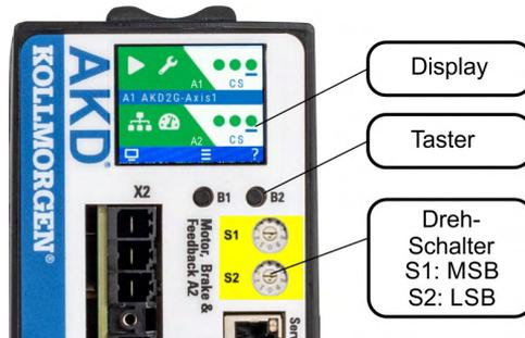
In der Anzeige an der Frontplatte des Servoverstärkers wird die Nummer des aufgetretenen Fehlers angezeigt. Sicherheitsfehler und -warnungen haben die gleiche 4-stellige Kodierung 90XX, dabei ist 90 ein 2-stelliger Gruppencode und XX eine zweistellige ID. Navigieren Sie mit B1 / B2 zum Fehlerbildschirm, der eine kurze Beschreibung des Fehlers oder der Warnung anzeigt. Details siehe WorkBench Onlinehilfe.
