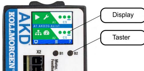
In der Anzeige an der Frontplatte des Servoverstärkers wird die Nummer des aufgetretenen Fehlers angezeigt. Sicherheitsfehler und -warnungen haben die gleiche 4-stellige Kodierung 90XX, dabei ist 90 ein 2-stelliger Gruppencode und XX eine zweistellige ID. Navigieren Sie mit B1 / B2 zum Fehlerbildschirm, der eine kurze Beschreibung des Fehlers oder der Warnung anzeigt. Details siehe WorkBench Onlinehilfe.
