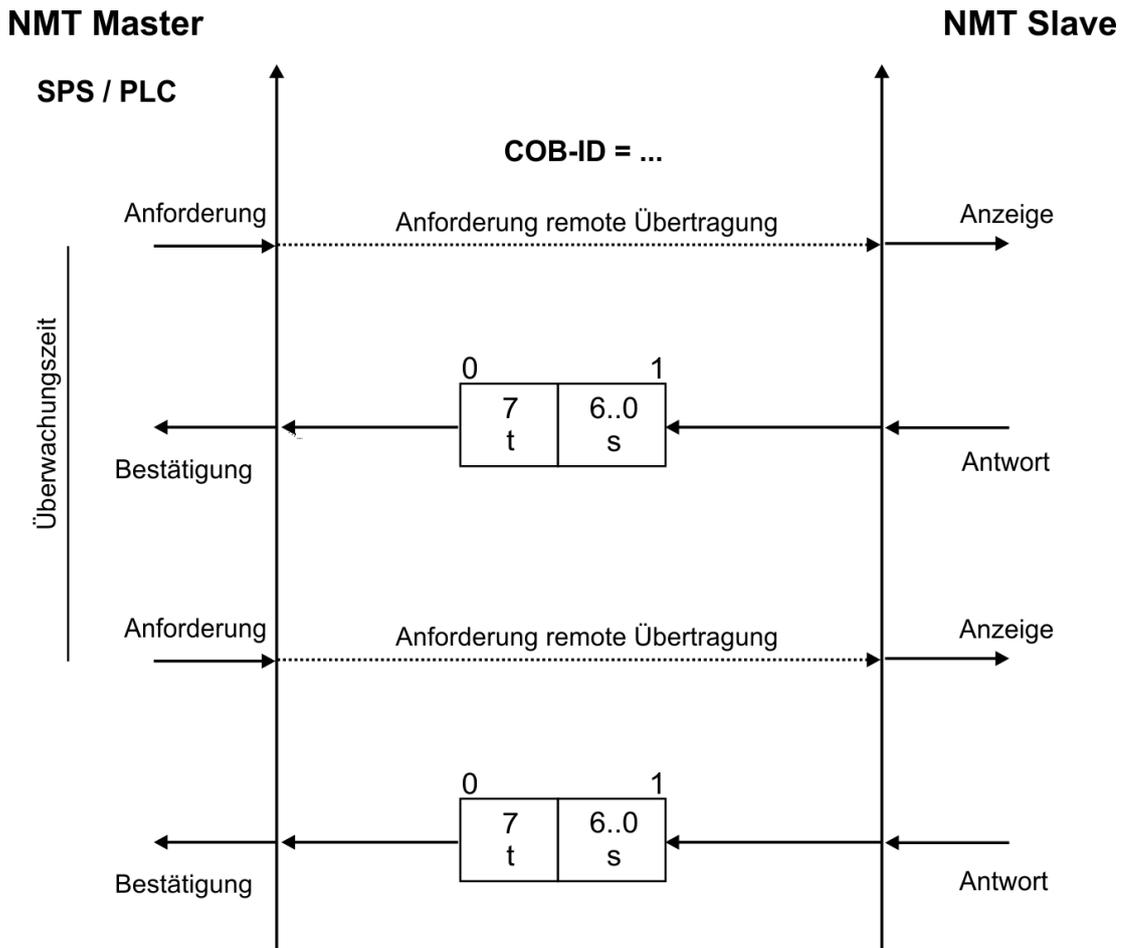
t = Umschalt-Bit, ändert seinen Zustand mit jedem Slave-Telegramm
