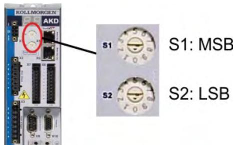
Die Drehschalter an der Frontplatte des AKD (S1 & S2) entsprechen der CAN-Stationsadresse. Die Schalter S1 & S2 entsprechen auch der IP-Adresseneinstellung des Verstärkers. Sowohl das CAN- als auch das IP-Netzwerkadressenschema müssen konfiguriert werden, um dieser Abhängigkeit Rechnung zu tragen, wenn das TCP/IP- und das CAN-Netzwerk in einer Anwendung gleichzeitig ausgeführt werden. Beispiel:
