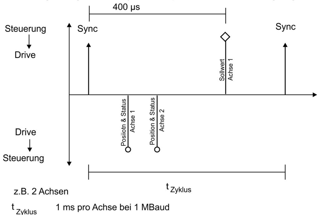
RPDO 2 kann jetzt für die Übertragung von Trajektorie-Daten für beide Achsen verwendet werden, z. B.:
