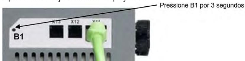
4. Quando o display piscar com a configuração do ajuste do interruptor rotativo, pare de pressionar o B1 e aguarde até que pare de piscar. Durante este período de tempo, o parâmetro FBUS.PARAM01 é ajustado para o novo valor e todos os parâmetros são armazenados na memória não volátil. A nova configuração será assumida na próxima inicialização.
