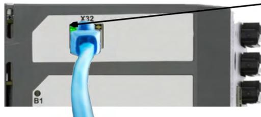
O LED fica verde se o drive estiver conectado através de um dispositivo de rede.
