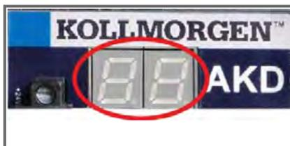
Se presente, os códigos de falha ou de advertência do AKD são exibidos constantemente. As mensagens de falha são codificadas com "F", e os avisos com "n". Com cartão de opção de E/S integrado, erros de operação do cartão SD são exibidos com um "E" seguido de 4 dígitos..
