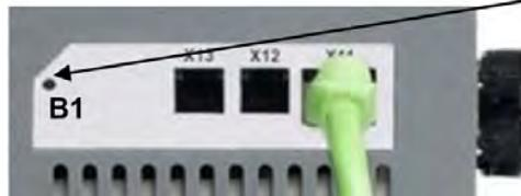
O display exibe **En** durante o processo de alteração do DRV.TYPE para EtherCAT.
