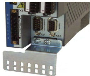
Modelli da AKD-x0306 a -x1206: piastra di messa a terra a L (in Europa soltanto)
