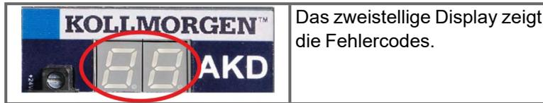
Die zusätzlichen Runtime Fehlermeldungen für AKD-T beginnen mit "F801". Alle Fehler beheben Sie mit: Fehler löschen, Programm korrigieren, neu kompilieren und downloaden, Programm neu starten.
