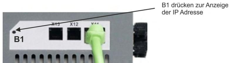
Sie können die Drehschalter verwenden, um den Wert für die IP-Adresse des AKD zu wählen. Bei CANopen und einigen anderen Feldbussen legen die Drehschalter auch die Stationsadresse des Servoverstärkers für das jeweilige Netzwerk fest.
