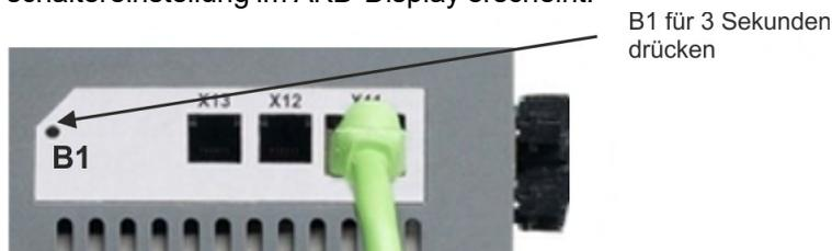
4. Wenn der Einstellwert des Drehschalters im Display blinkt, lassen Sie die Taste B1 los und warten Sie, bis das Blinken aufhört. Dabei wird der Parameter FBUS.PARAM01 auf den neuen Wert gesetzt, und alle Parameter werden gespeichert. Die neue Einstellung wird mit dem nächsten Einschalten des Servoverstärkers wirksam.
