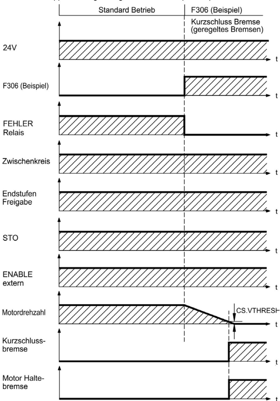
Wenn die Geschwindigkeit unter den Schwellenwert *CS.VTHRESH* abfällt oder es zu einer Zeitüberschreitung kommt, wird die Motorhaltebremse geschlossen (→ # 129).
