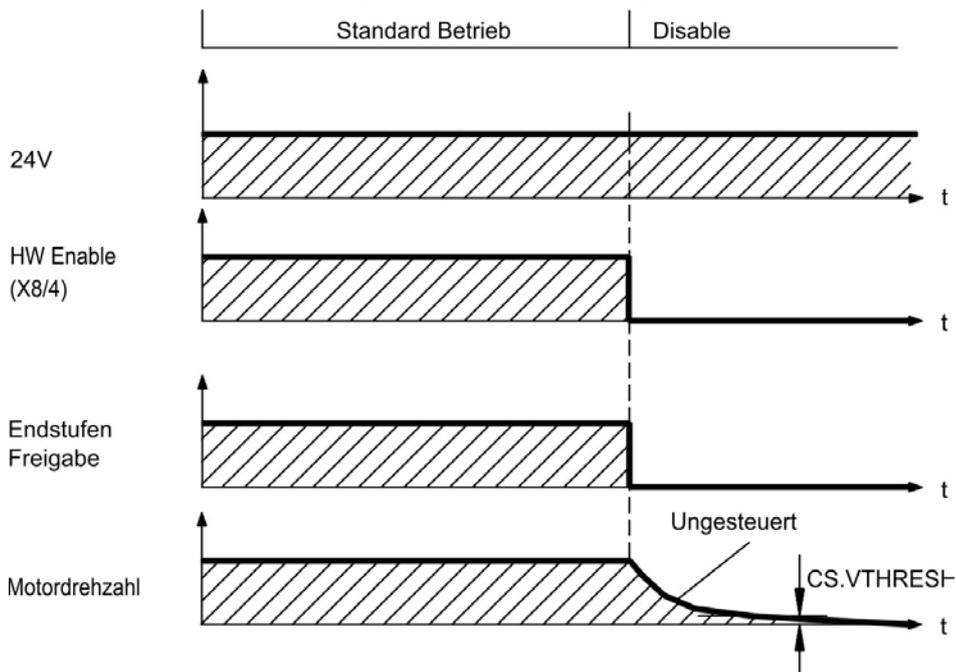
Wenn die Geschwindigkeit unter den Schwellenwert *CS.VTHRESH* abfällt oder es zu einer Zeitüberschreitung kommt, wird die Motorhaltebremse geschlossen (→ # 129). Setzen Sie bei vertikalen Achsen den Parameter *MOTOR.BRAKEIMM* auf 1, damit die Motorhaltebremse nach Hardware Disable ohne Verzögerung einfällt.
