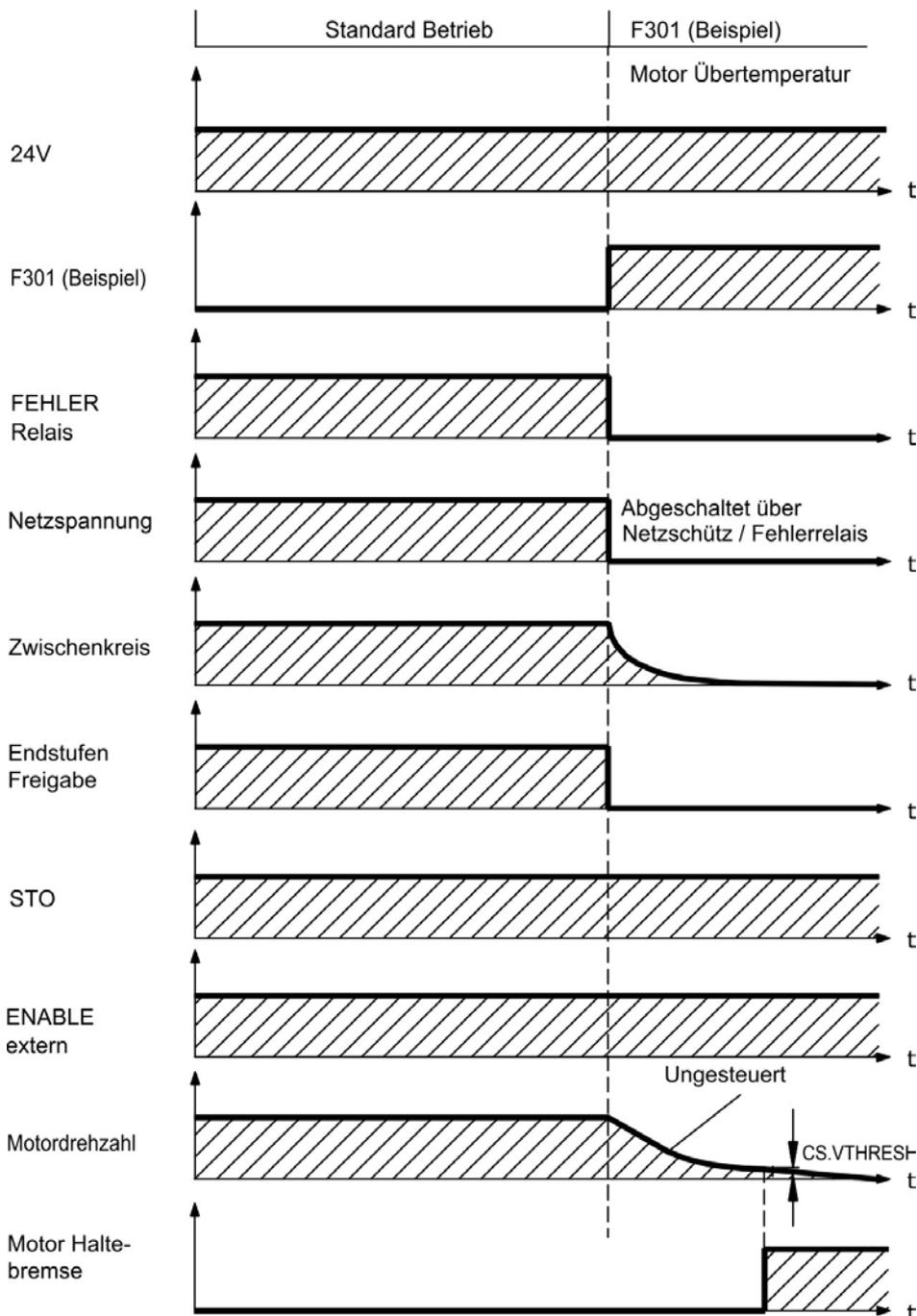
Wenn die Geschwindigkeit unter den Schwellenwert *CS.VTHRESH* abfällt oder es zu einer Zeitüberschreitung kommt, wird die Motorhaltebremse geschlossen (→ # 129). Setzen Sie bei vertikalen Achsen den Parameter *MOTOR.BRAKEIMM* auf 1, damit die Motorhaltebremse nach Fehler ohne Verzögerung einfällt.
