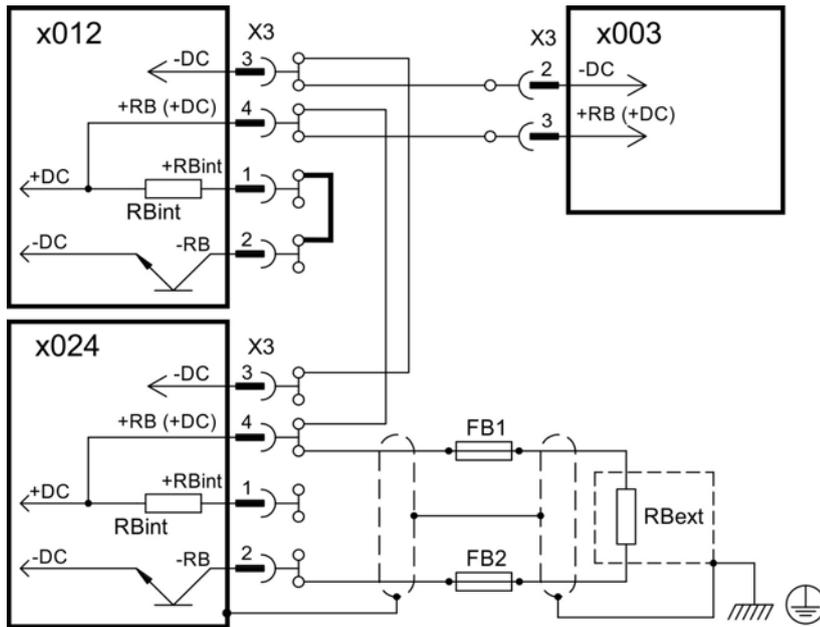
Wenn ein Gerät durch z.B. einen internen Kurzschluss ausfällt, können ohne externe DC Sicherungen weitere Geräte im Verbund beschädigt oder zerstört werden. Sollen viele Verstärker parallel geschaltet werden, so ist es sinnvoll, Zwischenkreissicherungen (→ # 45) zwischen Verstärkergruppen (eine Gruppe bestehend aus zwei oder drei Geräten, je nach Stromstärke) einzufügen, um einen möglichen Folgeschaden zu begrenzen. Vollständig verhindern kann die Sicherung einen Folgeschaden nicht.
