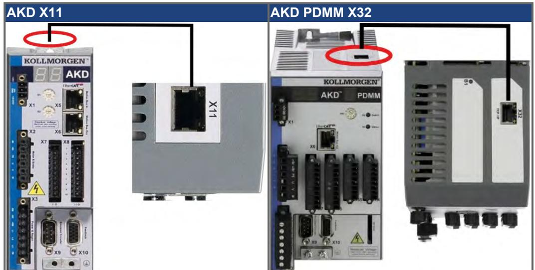
Schließen Sie die Serviceschnittstelle (X11 oder X32) des Verstärkers an eine Ethernet-Schnittstelle am PC direkt oder über einen Netzwerkhub/-switch an, **während die Stromversorgung zu den Geräten abgeschaltet ist**. Verwenden Sie bevorzugt Standard-Ethernetkabel der Kategorie 5.
