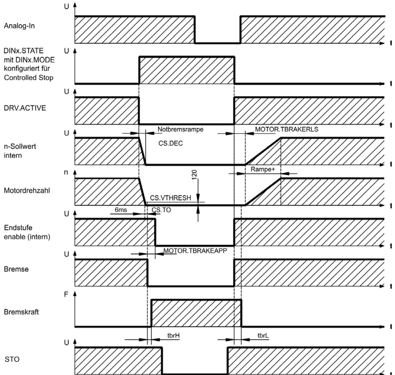
Der Geschwindigkeitssollwert des Servoverstärkers wird intern entlang einer einstellbaren Rampe (CS.DEC) nach 0V heruntergeregelt.
