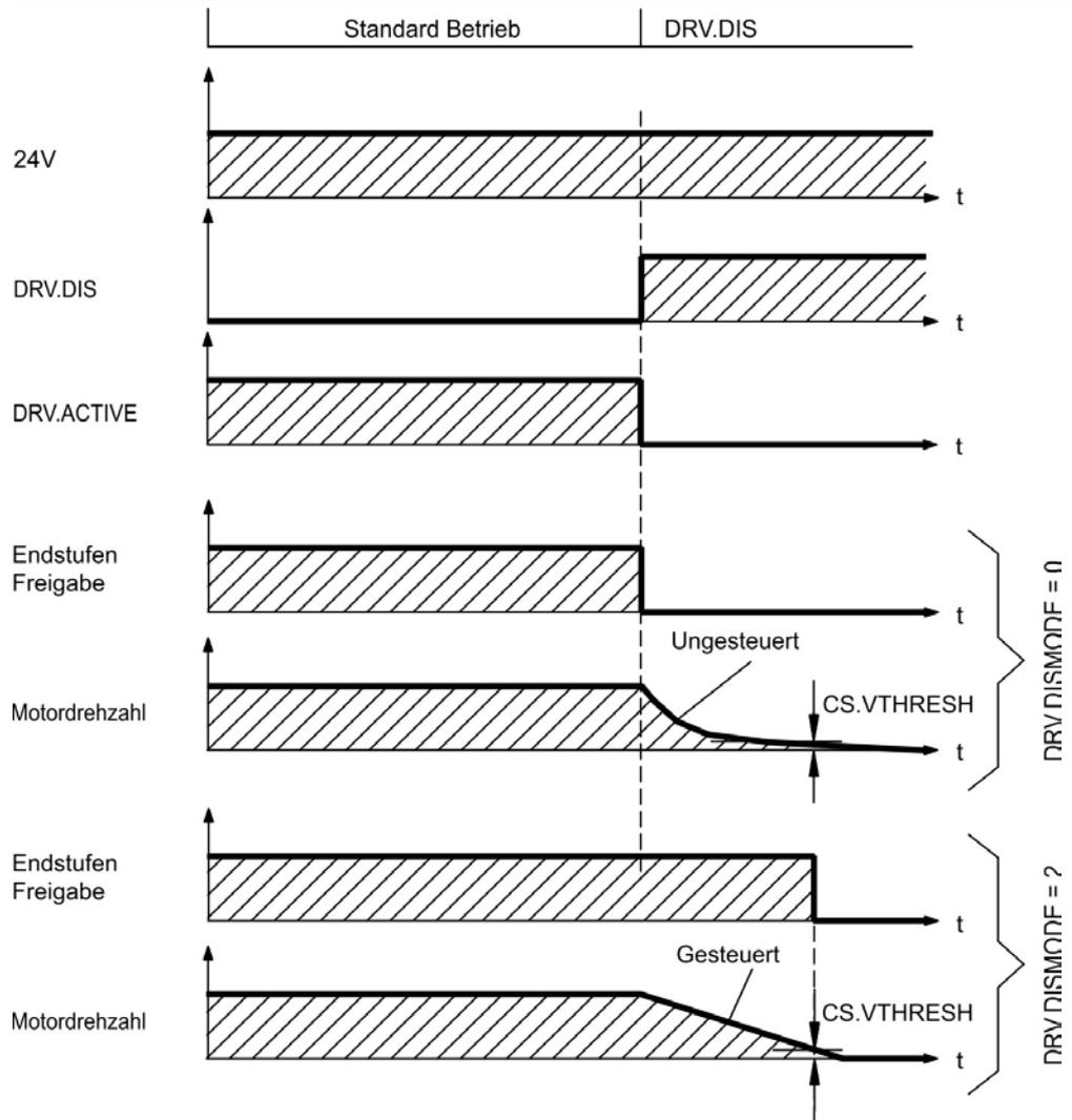
Wenn die Geschwindigkeit unter den Schwellenwert  $CS.VTHRESH$  abfällt oder es zu einer Zeitüberschreitung kommt, wird die Motorhaltebremse geschlossen (→ # 129).
