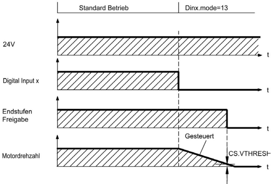
Wenn die Geschwindigkeit unter den Schwellenwert  $CS.VTHRESH$  abfällt oder es zu einer Zeitüberschreitung kommt, wird die Motorhaltebremse geschlossen (→ # 129).
