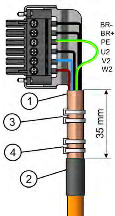
1. Isolieren Sie die äußere Kabelummantelung auf eine Länge von ca. 120 mm ab und achten Sie darauf, das Schirmgeflecht nicht zu beschädigen.
