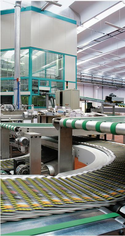
A substituição da transmissão mecânica pelos motores direct-drive aumenta o desempenho no que se refere a velocidade, resultado e qualidade.
