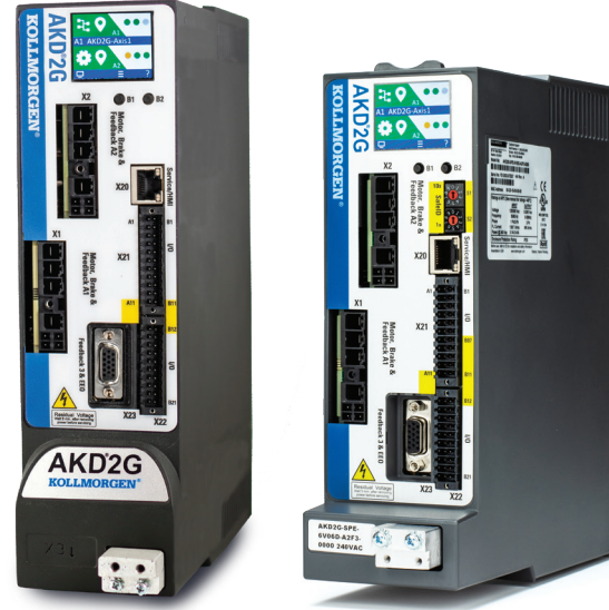
Çift Eksenli AKD2G 480 Vac (isteğe bağlı geri besleme ve I/O genişletmesi ile gösterilmiştir)
