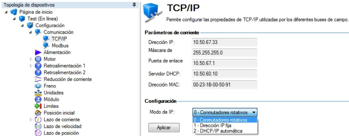
Existen tres modos en el Modo IP en la pantalla TCP/IP con los que la dirección IP puede configurarse.
