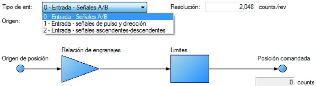
La resolución es el valor de poscuadratura de conteos/revolución de la entrada. Además, se puede aplicar una relación de engranajes para incidir en la relación de salida del motor.
