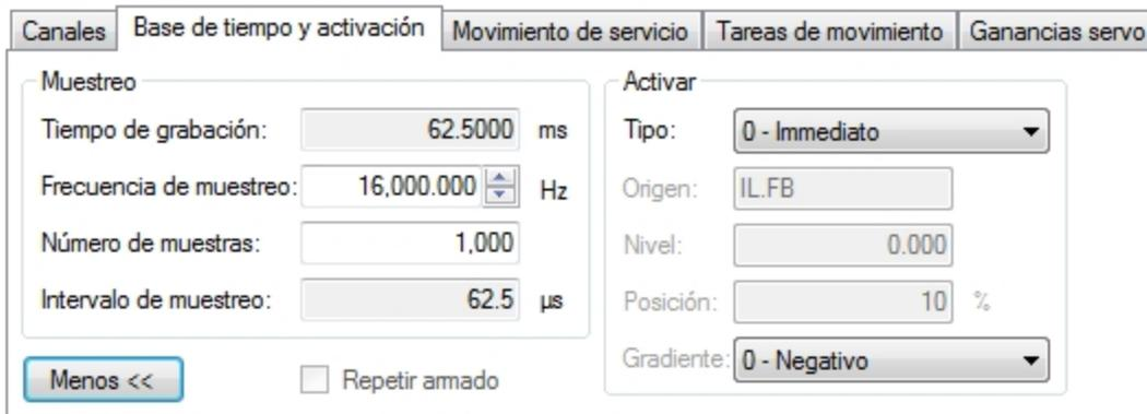
En el área **Muestreo** de esta vista, se puede especificar la duración de la grabación; para ello, se debe introducir la frecuencia de muestreo y una cantidad de muestras. Aquí, el tiempo de grabación es un valor calculado que se presenta a modo de referencia.
