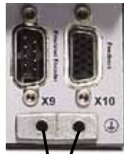
Abbildung 2 Anschluss der Schutzerde (PE)
