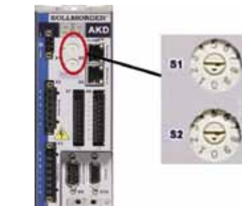
Abbildung 11 Drehschalter für statische IP-Adressierung IP-Adresse = 192.168.0.S1S2
