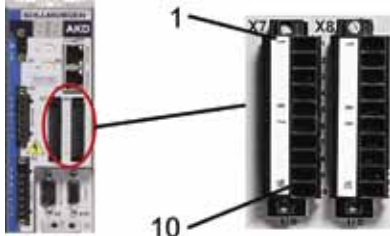
Abbildung 8 E/A-Verbindung für Pin-Konfiguration
