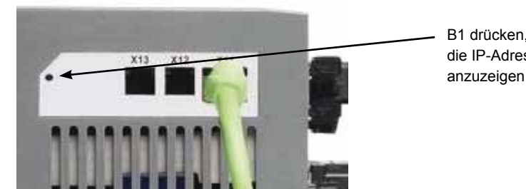
Abbildung 16 Taste B1 zur Anzeige der IP-Adresse
