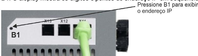
2. Inserir o endereço IP do drive. Após determinar o endereço IP, insira-o manualmente no campo **Especificar endereço** no WorkBench. Em seguida, clique em **Próximo** para se conectar.
