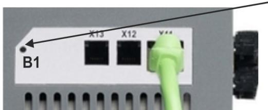
La pantalla de siete segmentos muestra **En** durante el proceso de cambio de DRV.TYPE a EtherCAT. **No desconecte el suministro de energía de 24 [V] mientras los siete segmentos muestran En.**
