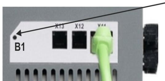
3. Cuando en la pantalla parpadee la configuración del conmutador rotativo, deje de presionar B1 hasta que deje de parpadear. Durante ese tiempo, el parámetro FBUS.PARAM01 se configura con el valor nuevo y todos los parámetros se guardan en la memoria no volátil. La nueva configuración se tomará con el nuevo encendido de la unidad.
