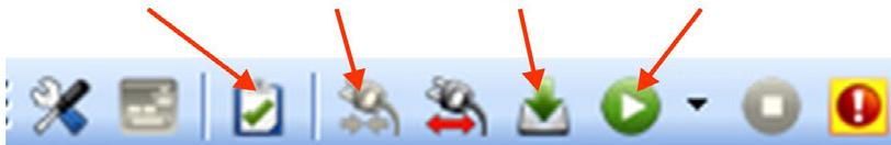
Haga doble clic en EtherCAT en la vista de proyecto para abrir la vista de dispositivos EtherCAT. Haga clic en los dispositivos de escaneo de la esquina superior derecha y KAS IDE identificará su unidad automáticamente y la agregará.
