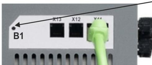
La pantalla de siete segmentos muestra **Cn** durante el proceso de cambio de DRV.TYPE a CAN.
