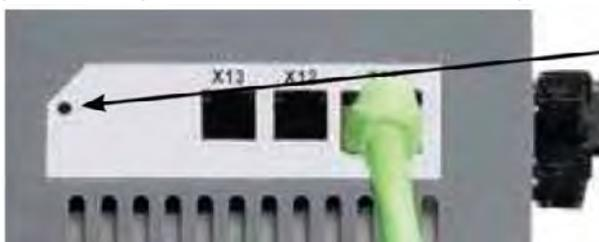
Premi B1 per visualizzare il velocità di trasmissione
