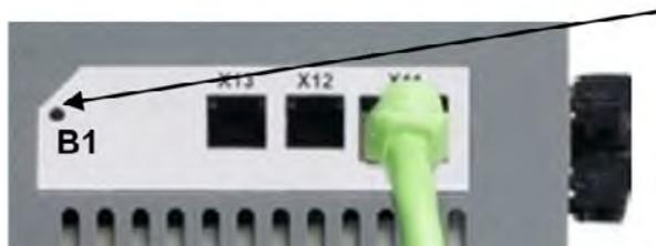
Mentre si modifica DRV.TYPE impostando il bus di campo CAN, il display a sette segmenti mostra **Cn**. **Non interrompere l'alimentazione a 24 V quando il display a sette segmenti mostra Cn!**
