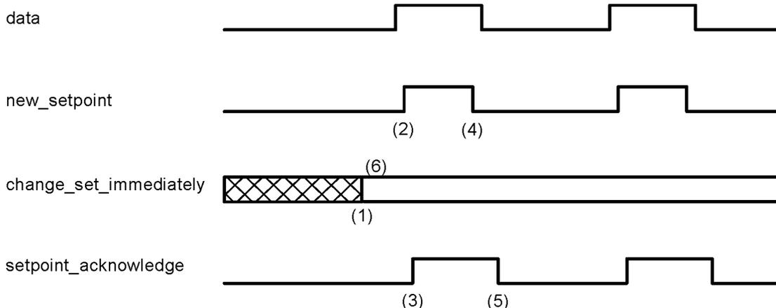
Le immagini mostrano la differenza tra la modalità `set_of_setpoints` e la modalità `setpoint singolo`. Lo stato iniziale del bit `change_set_immediately` nella parola di controllo determina quale modalità è utilizzata. Per semplificare questi esempi, sono utilizzati solo i movimenti trapezoidali.
