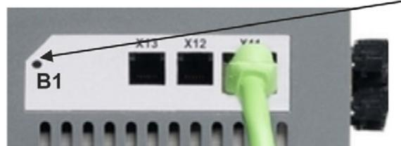
Mentre si modifica DRV.TYPE impostando il bus di campo EtherCAT, il display a sette segmenti mostra **En. Non interrompere l'alimentazione a 24 V quando il display a sette segmenti mostra En!**
