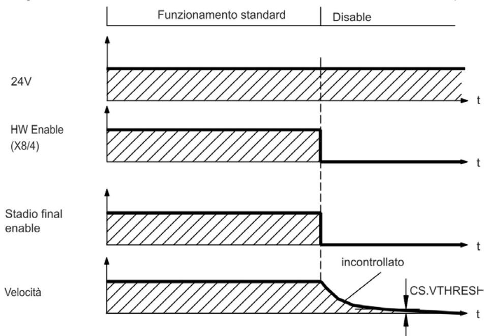
Se la velocità scende al di sotto della soglia *CS.VTHRESH* o se si verifica un timeout nel corso di una procedura di arresto, il freno viene chiuso (→ p. 104). Per gli assi verticali
