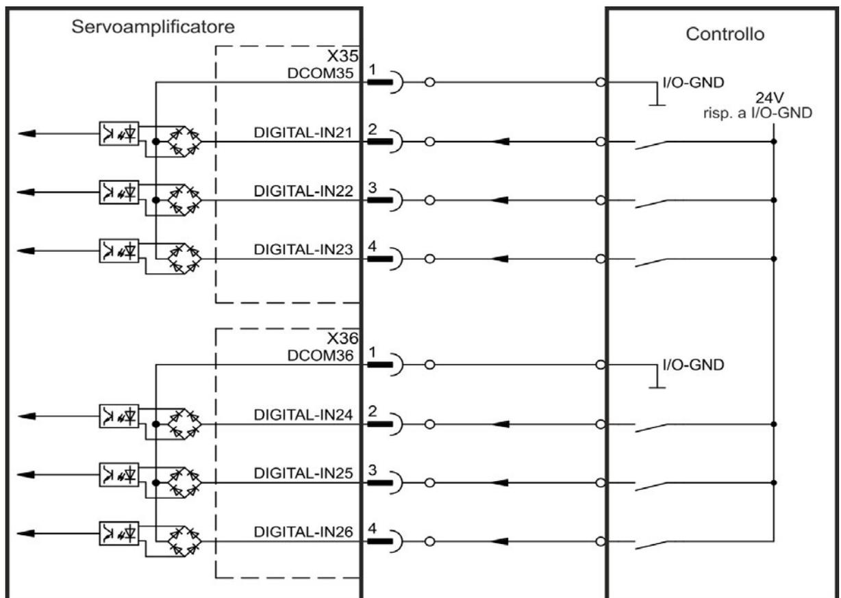
**Schema dei collegamenti degli ingressi digitali (collegamento di tipo sink, esempio)**
