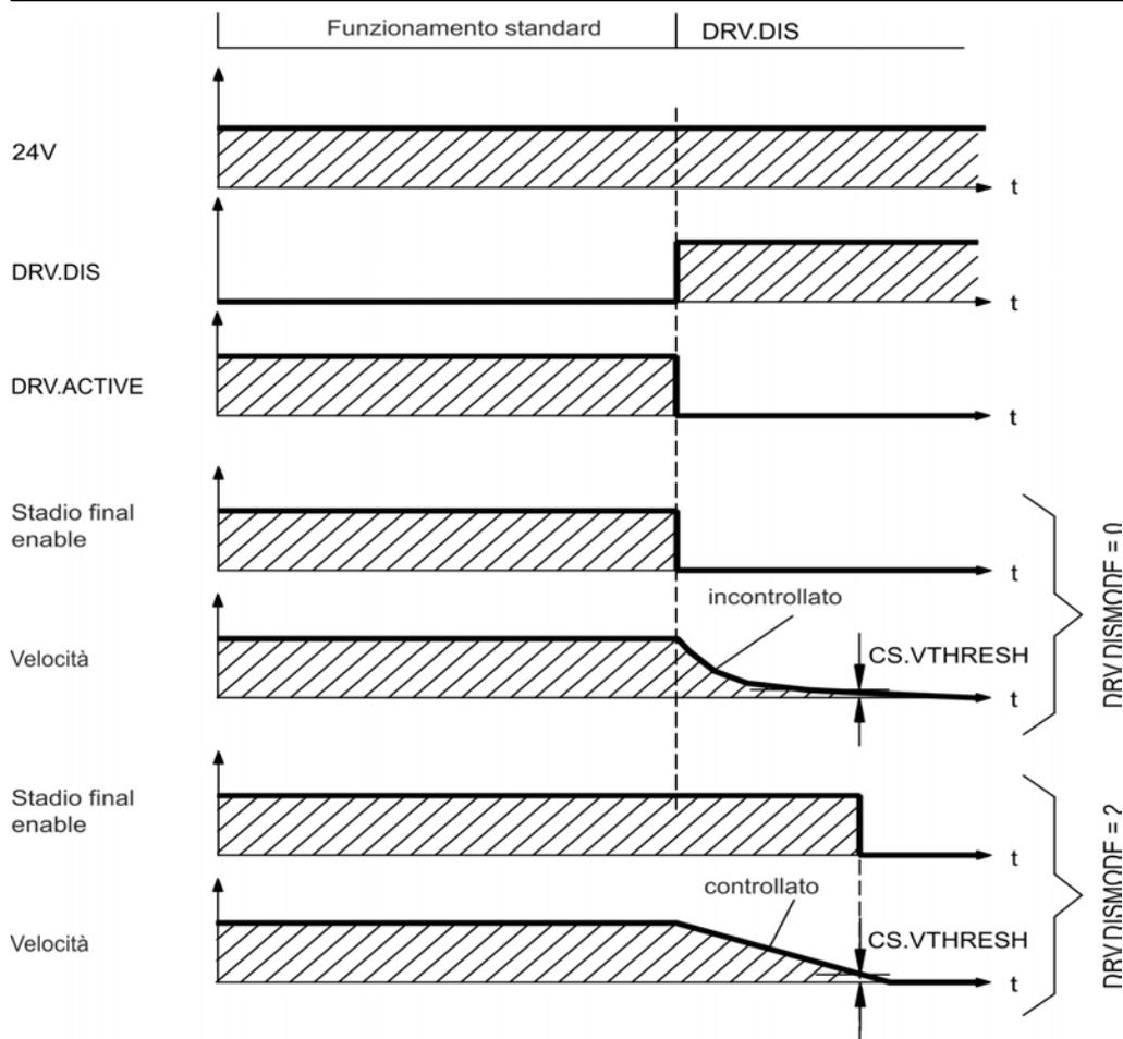
Se la velocità scende al di sotto della soglia *CS.VTHRESH* o se si verifica un timeout nel corso di una procedura di arresto, il freno viene chiuso (→ p. 104).
