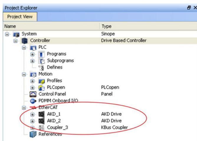
Per comunicare direttamente con un amplificatore senza avviare il progetto, cliccare sul simbolo EtherCAT nell'albero di progetto. Selezionare l'amplificatore desiderato (1) e cliccare su **Online Configuration** (2):
