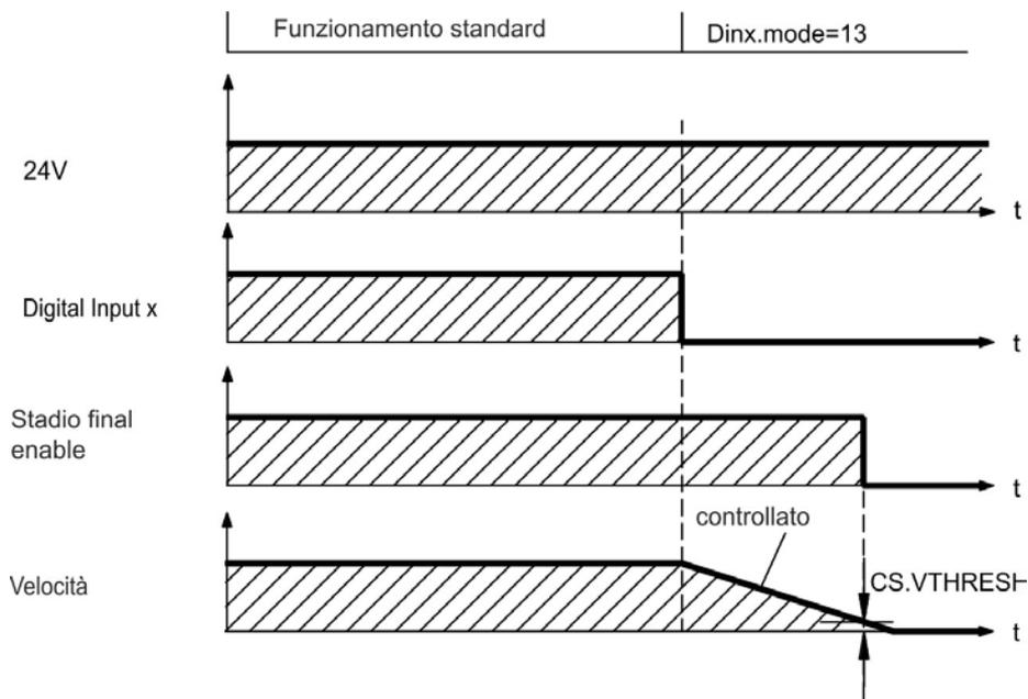
Se la velocità scende al di sotto della soglia *CS.VTHRESH* o se si verifica un timeout nel corso di una procedura di arresto, il freno viene chiuso (→ p. 104).
