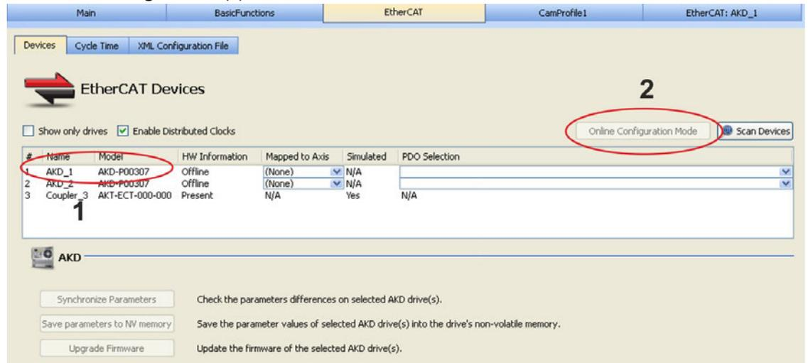
Nella finestra di lavoro si apre ora la già nota finestra di avvio WorkBench che consente di accedere a tutti i parametri di configurazione dell'amplificatore:
