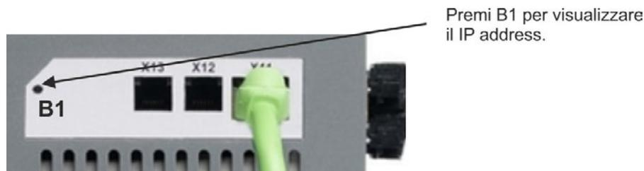
Si può usare selettori rotativi per selezionare il valore dell'indirizzo IP per accedere al servoamplificatore dall'interfaccia di servizio. Per CANopen e altri bus di campo, i selettori rotativi impostano anche l'indirizzo del nodo del servoamplificatore per una specifica rete.
