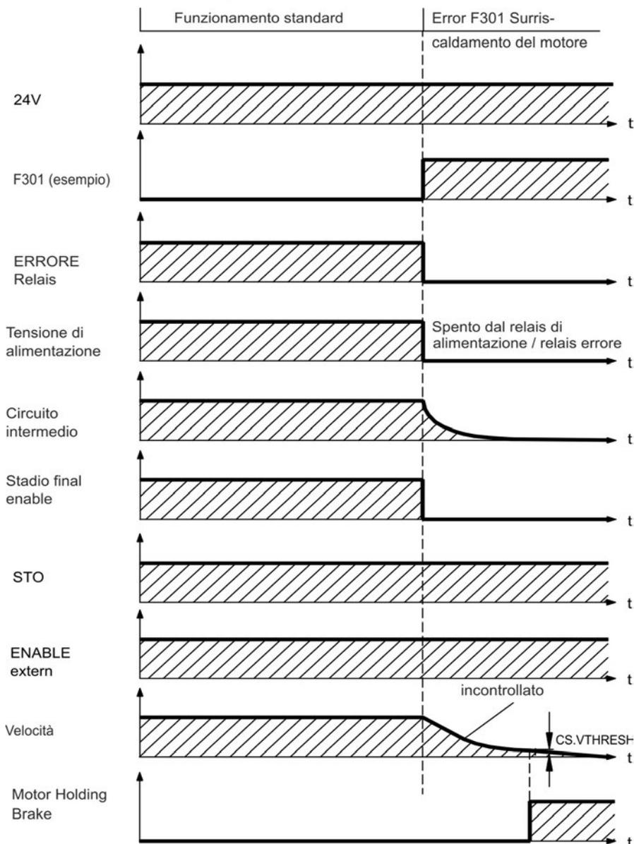
Se la velocità scende al di sotto della soglia  $CS.VTHRESH$  o se si verifica un timeout nel corso di una procedura di arresto, il freno viene chiuso (→ p. 104). Per gli assi verticali impostare il parametro MOTOR.BRAKEIMM su 1, affinché in seguito a errori o disabilitazione dell'hardware il freno funzioni senza ritardi.
