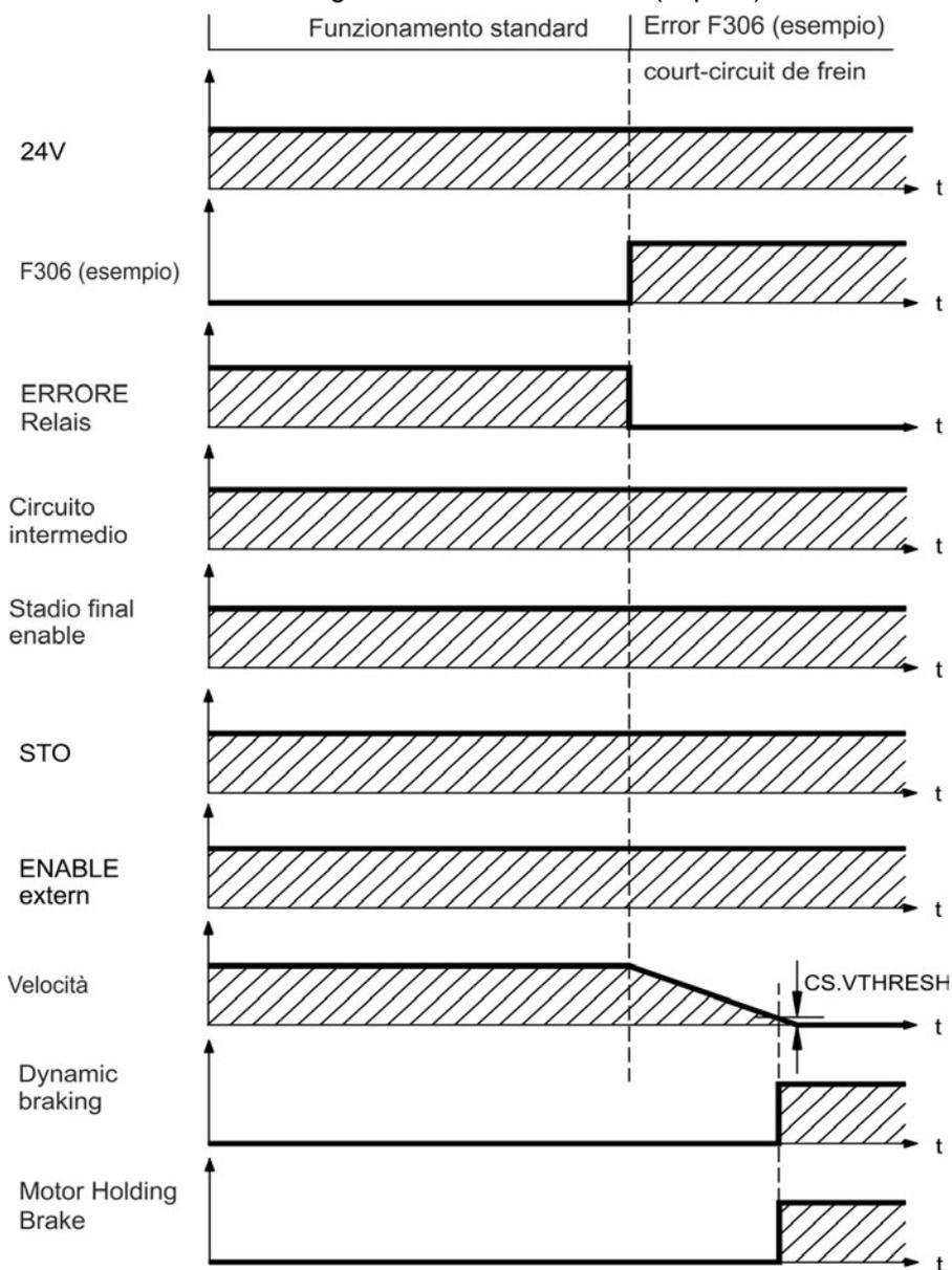
Se la velocità scende al di sotto della soglia  $CS.VTHRESH$  o se si verifica un timeout nel corso di una procedura di arresto, il freno viene chiuso (→ p. 104).
