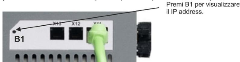
2. Inserimento dell'indirizzo IP del servoamplificatore. Dopo aver stabilito l'indirizzo IP, digitare l'indirizzo IP del servoamplificatore nella casella **Specifica indirizzo** di WorkBench. Quindi fare clic su **Avanti** per eseguire il collegamento.
