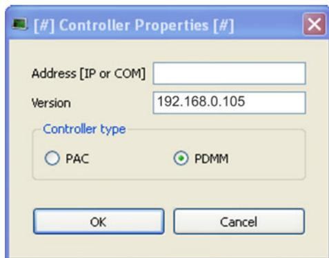
Inserire l'indirizzo IP del AKD PDMM, impostare il **Controller Type** su PDMM e cliccare su OK. Per creare il collegamento a AKD PDMM utilizzare i seguenti comandi:
